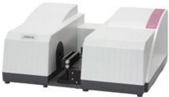
**Slika 13.** UV/Vis spektrofotometar Scinco S-3100, Scinco CO., LTD
