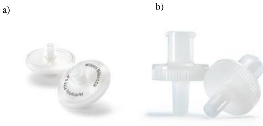
**Slika 17.** Milipore Millex-LCR, Hydrophilic PTFE fileri, veličine čestica 0,45 µm (a) te 0,25 µm (b)
