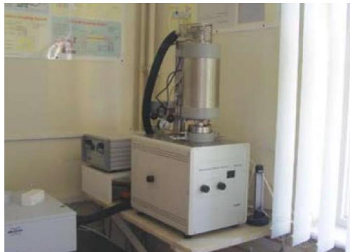
**Slika 6.** Termogravimetrijski analizator (TGA) NetzschSTA409
