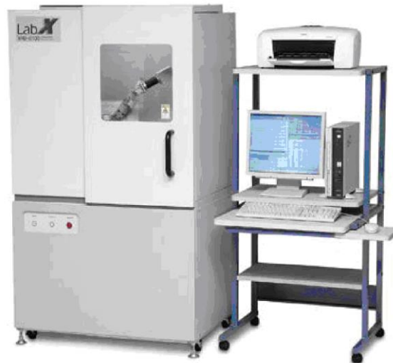
Slika 4. Rendgenski difraktometar Shimadzu XRD 6000
