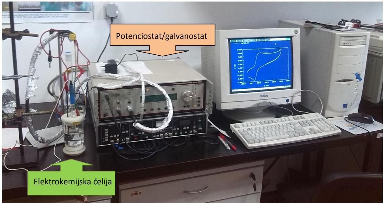
Slika 3.2. Aparatura korištena za elektrokemijska mjerena
