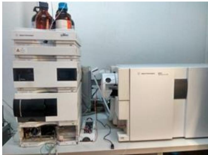
**Slika 13.** Agilent 1200 s Agilent 6410 trostrukim kvadripolnim analizatorom masa
