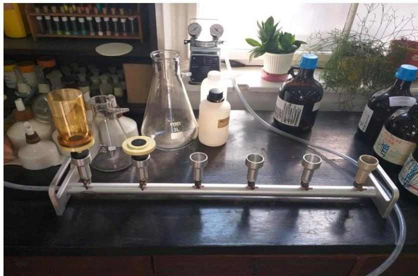
**Slika 12.** Pall Life Science uređaj za filtraciju
