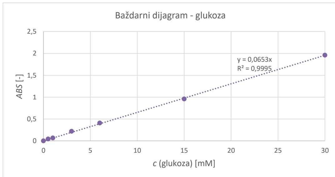
**Slika 8.1** Baždarni dijagram za određivanje koncentracije glukoze
