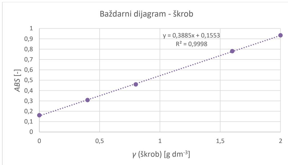
**Slika 8.2** Baždarni dijagram za određivanje koncentracije škroba
