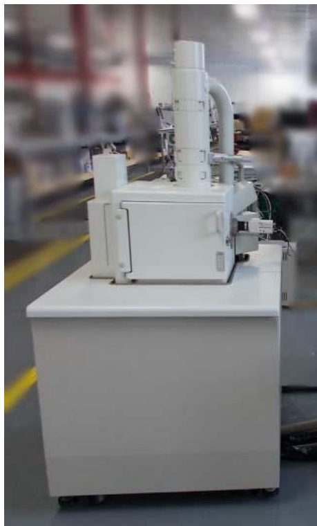
Slika 18. Pretražni elektronski mikroskop Jeol JSM – 5800
