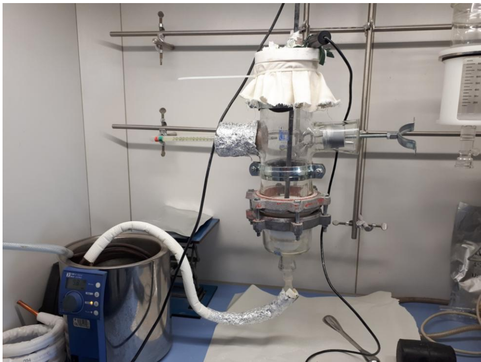
Slika 15. Sušionik s fluidiziranim slojem
