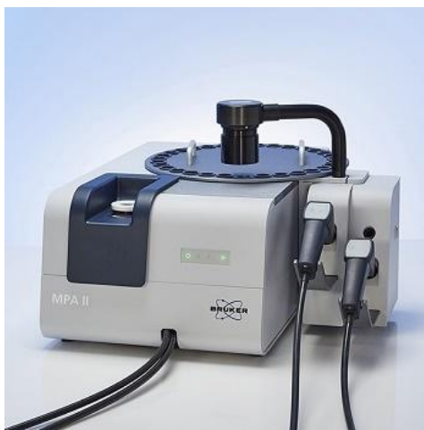
Slika 16. Uređaj za snimanje spektra, Bruker
