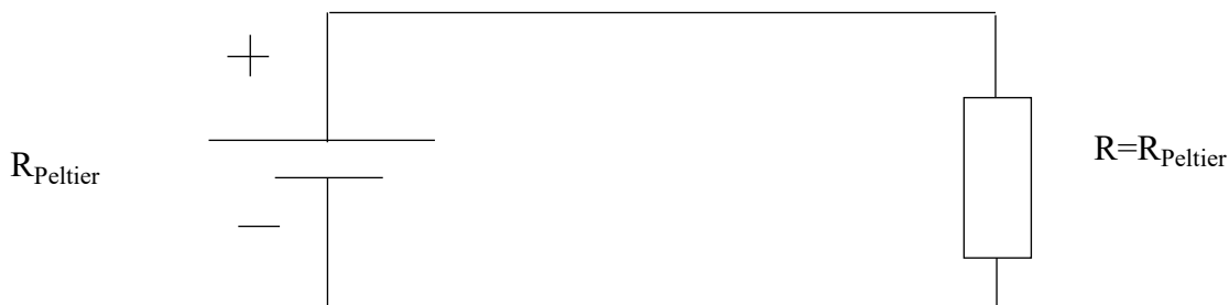
Slika 5. Shematski prikaz strujnog kruga Peltierovog elementa i trošila
