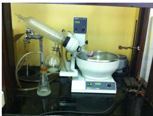
Slika 20. Rotavapor, Büchi Rotavapor R-114 [13]
