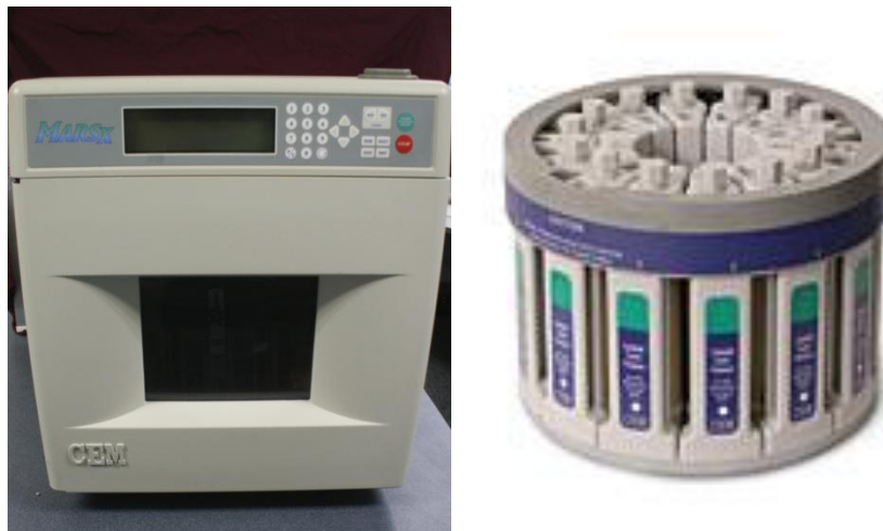
Slika 18. Uređaj za mikrovalnu ekstrakciju s teflonskim posudama za uzorke [11]
