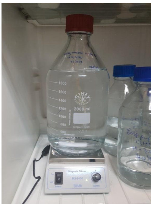
Slika 11. Dijaliza taloga u fosfatnom puferu
