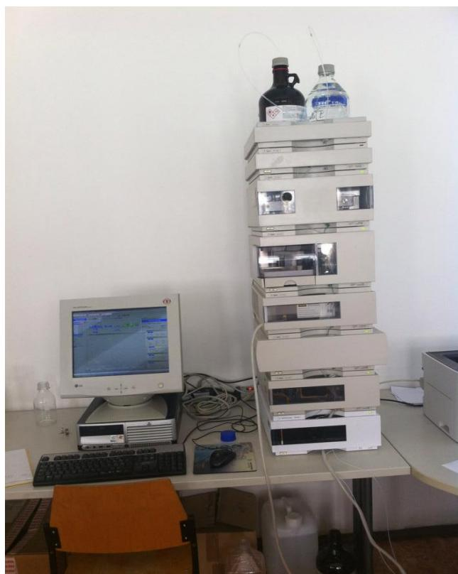
**Slika 18.** Kromatografski sustav Agilent 1100 (Agilent Tehnologies, USA)
