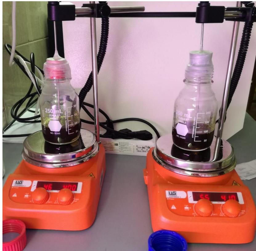
Slika 14. Prikaz sustava za provođenje adsopcije adsorbensima Sorbsil R40 i R92
