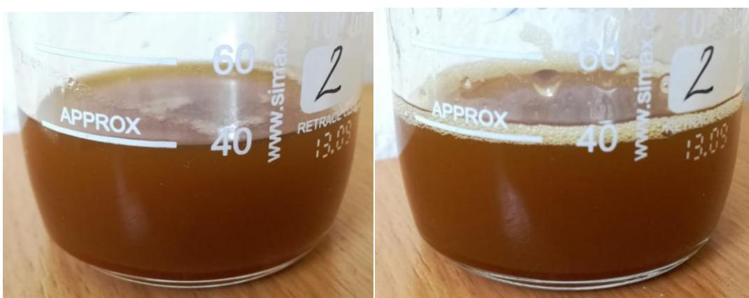
Slika 15. Prikaz smjese adsorbensa i masti prije (lijevo) i nakon (desno) adsorpcije
