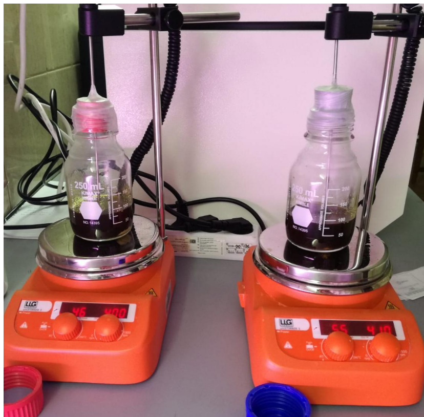
Slika 14. Prikaz sustava za provođenje adsorpcije adsorbensima Sorbsil R40 i R92
