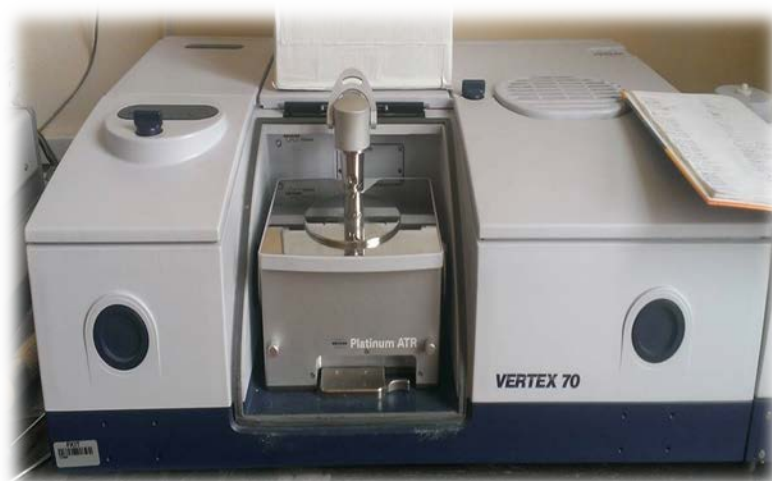
Slika 5.2. Fotografija FTIR spektrofotometra Bruker Vertex 60 s platinastim detektorom
