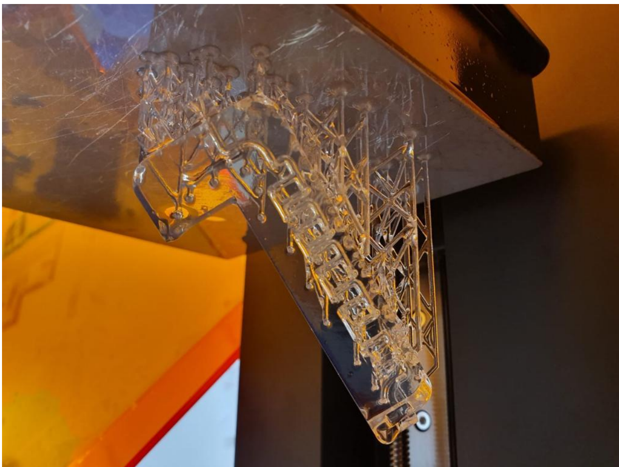
Slika 2.5. Milireaktor izrađen postupkom stereolitografije
