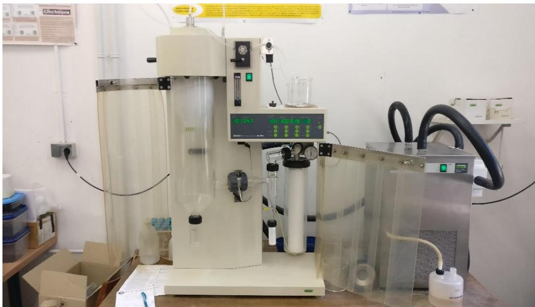
*Slika 14.* Sušionik s raspršivanjem B-290, BüchiLabortechnik AG
