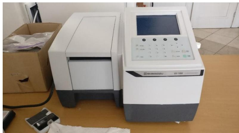
Slika 16. UV/Vis spektrofotometru Shimadzu UV-1280
