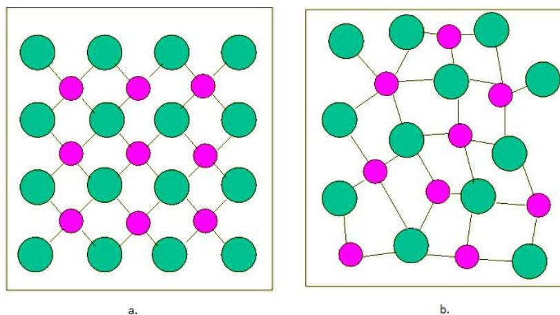
Slika 12. Vrste struktura: a) kristalna; b) amorfna struktura [8]
