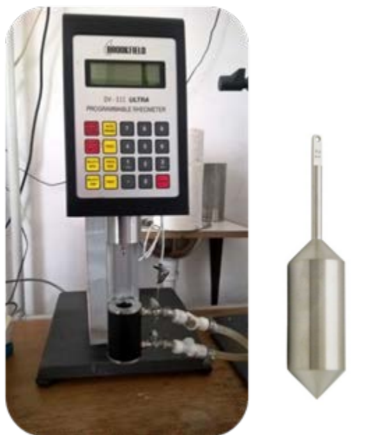
Slika 6. a) Rotacijski viskozimetar Brookfield DV – III ULTRA , b) vreteno SC4-21
