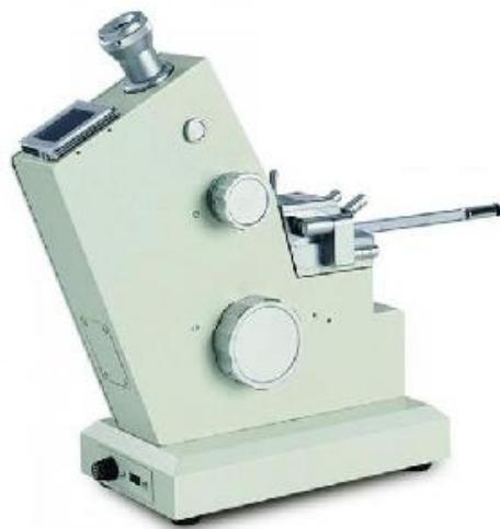
Slika 7. Refraktometar, OPTECH RMI
