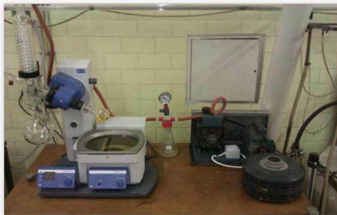
Slika 4. Rotacijski vakuum isparivač *IKA RV 10, Basic.*
