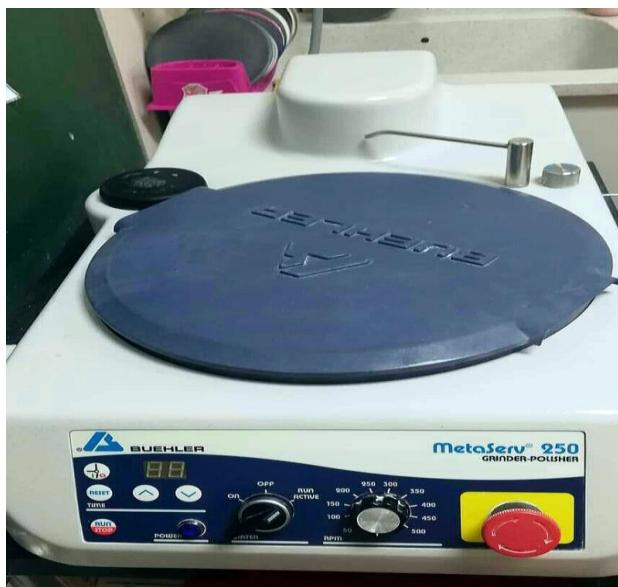
Slika 5. Uređaj za poliranje Buehler MetaServ 250
