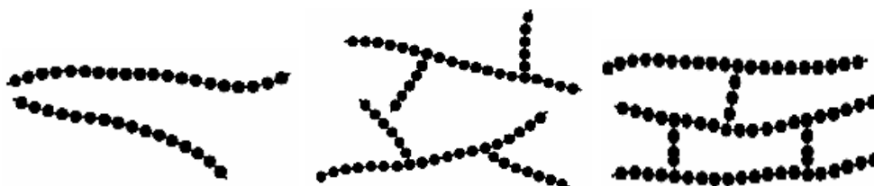
Slika 2.2.1. Shematski prikaz linearnih makromolekula, razgranatih i umreženih makromolekula 7
