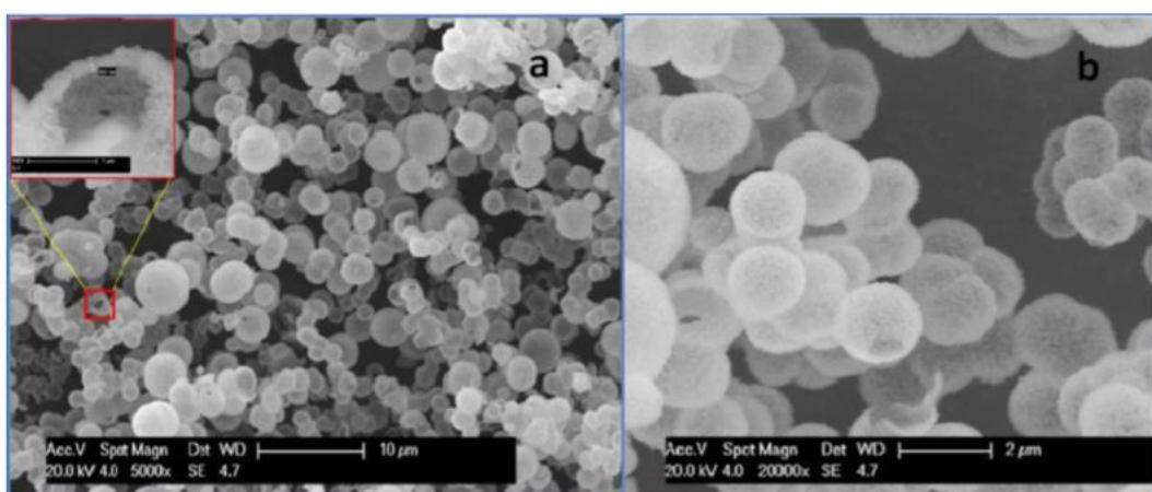
Slika 12.<sup>19</sup>: SEM i (b) tipična međusobna povezanost zrna itrijem stabilizirane cirkonijoksidne keramičke pjene šuplja sfera (YSZ). Na slici a) pokazuje poprečni presjek tipične šuplje sfere (gornji lijevi kut)
