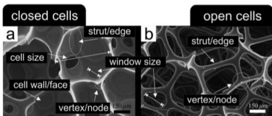
Slika 3.<sup>10</sup> Strukturni elementi zatvorene i otvorene čelije
