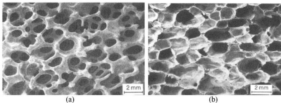
Slika 2.<sup>10</sup> 3D mikrostruktura keramičke pjene ; a – otvorene pore, b – zatvorene pore
