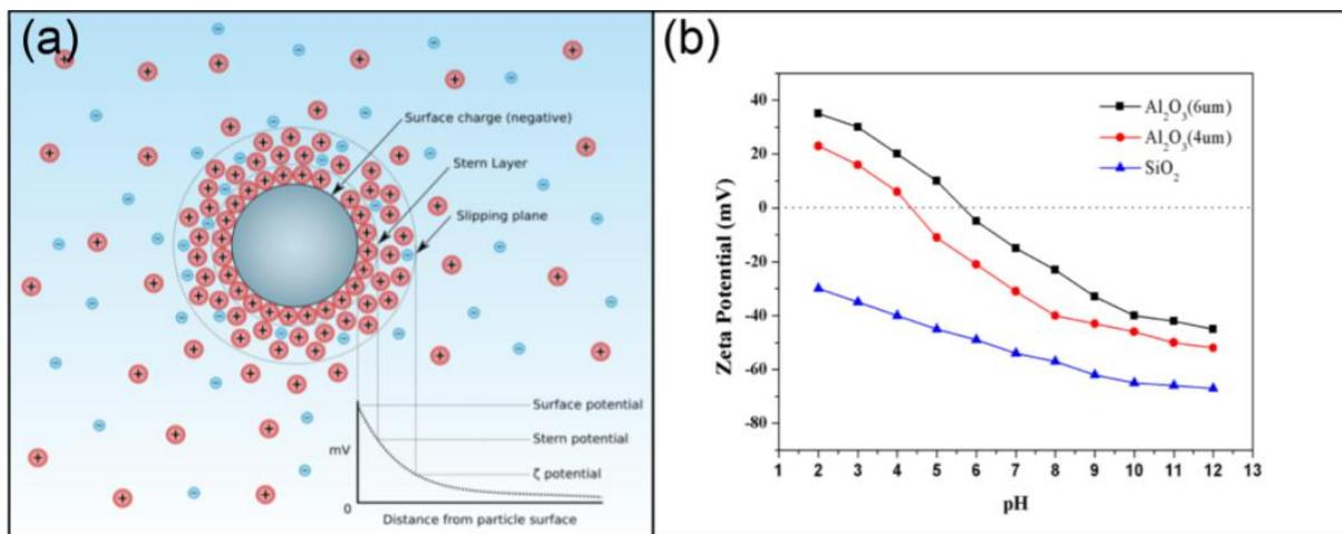
Slika 10.<sup>18</sup> Raspodjela naboja u koloidnoj suspenziji: viši naboji na površini čestica mogu stabilizirati sustav (a) Zeta potencijal sirovog Al<sub>2</sub>O<sub>3</sub> i SiO<sub>2</sub> koloidnih čestica (b)
