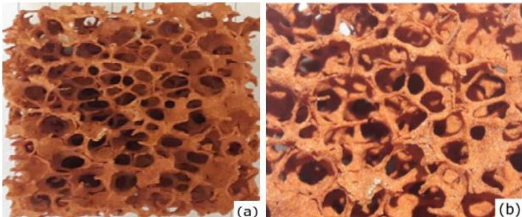
Slika 13.<sup>20</sup>  $\text{Al}_2\text{O}_3$  keramički filteri, a) prikazuje homogenu raspodjelu pora,
