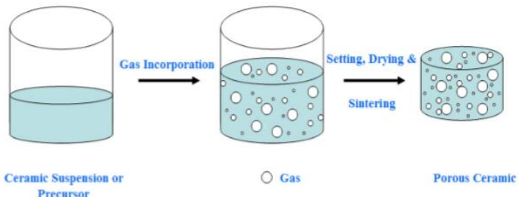
Slika 9.<sup>3</sup> Shematski prikaz procesa izravnog pjenjenja
