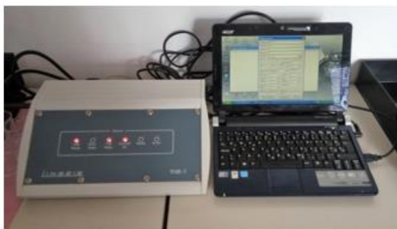
b) Uređaj i program za mjerenje toplinske vodljivosti
