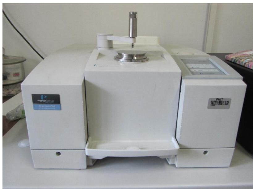
*Slika 14. Instrument za infracrvenu spektroskopsku metodu*
