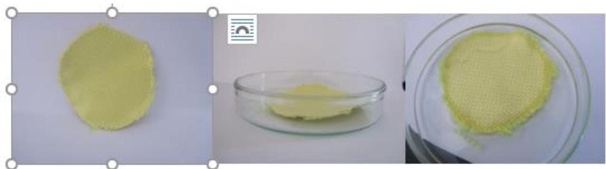
*Slika 12. a) Aramidno vlakno korišteno za probni test b) Aramidno vlakno u petrijevoj zdjelici c) Uranjanje kevlara u 10 % -tni nanofluid*
