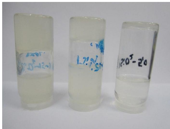
*Slika 24.* Preokrenute bočice uzoraka nanofluida sa udjelom  $\text{SiO}_2$  0,5 % 10 % i 20 %
