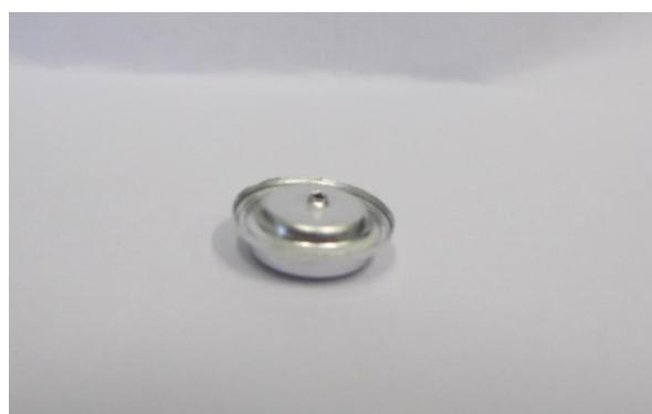
*Slika 11. Posudica s poklopcem za uzorak za DSC mjerena*
