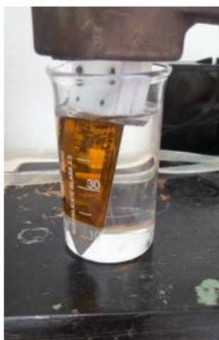
Slika 9. a) Senzor uronjen u nanofluid
