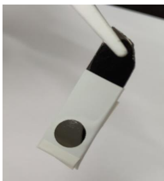
Slika 3.5. Pločica od staklastog ugljika pripremljena za sintezu vodljivog polimera.
