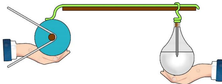
Slika 2.1. Shematski prikaz punjenja leidenske boce iz elektrostatičkoga stroja.
