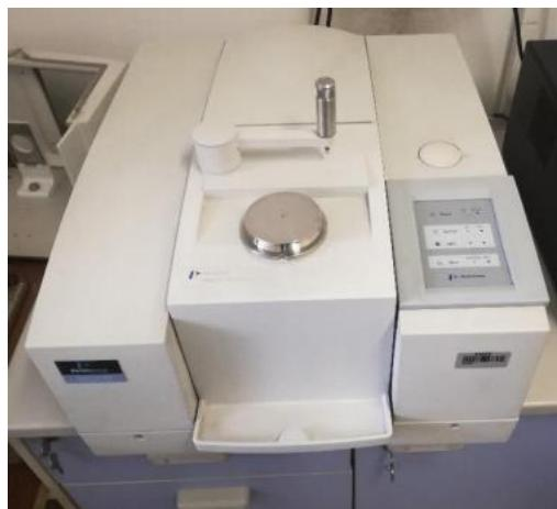
**Slika 38.** Infracrveni spektrofotometar s Fourierovom transformacijom signala PerkinElmer Spectrum One opremljen s ATR dodatkom.
