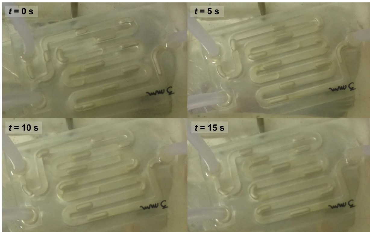
Slika 64. Fotografija milireaktora u uljnoj kupelji tijekom sinteze T = 60\text{ }^{\circ}\text{C} , \varphi = 3,0\text{ mm} , \tau = 7,5\text{ min} .
