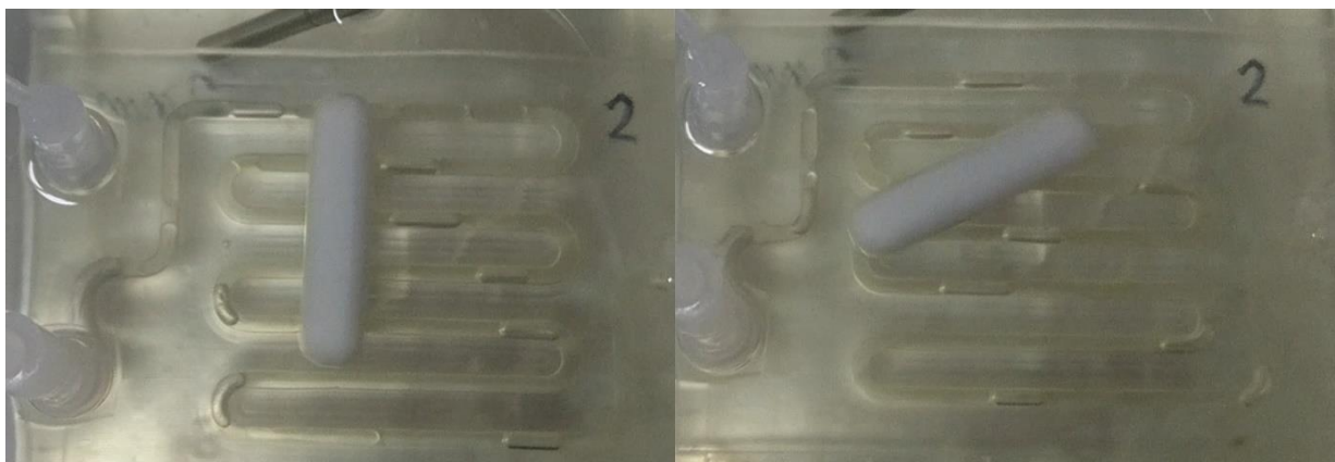
Slika 63. Fotografija milireaktora u uljnoj kupelji tijekom sinteze T = 60\text{ }^{\circ}\text{C} , \varphi = 2,0\text{ mm} , \tau = 7,5\text{ min} .
