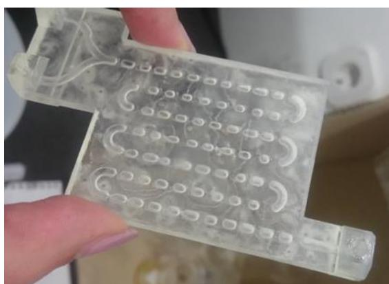
**Slika 48.** Fotografija milireaktora s oscilirajućim tokom fluida RSP-370-SLA.
