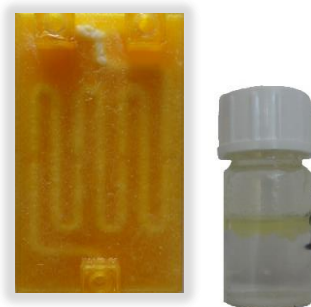
Slika 79. Milireaktor izrađen od PETG-a nakon provedene sinteze i skupljeni produkt u vijali.
