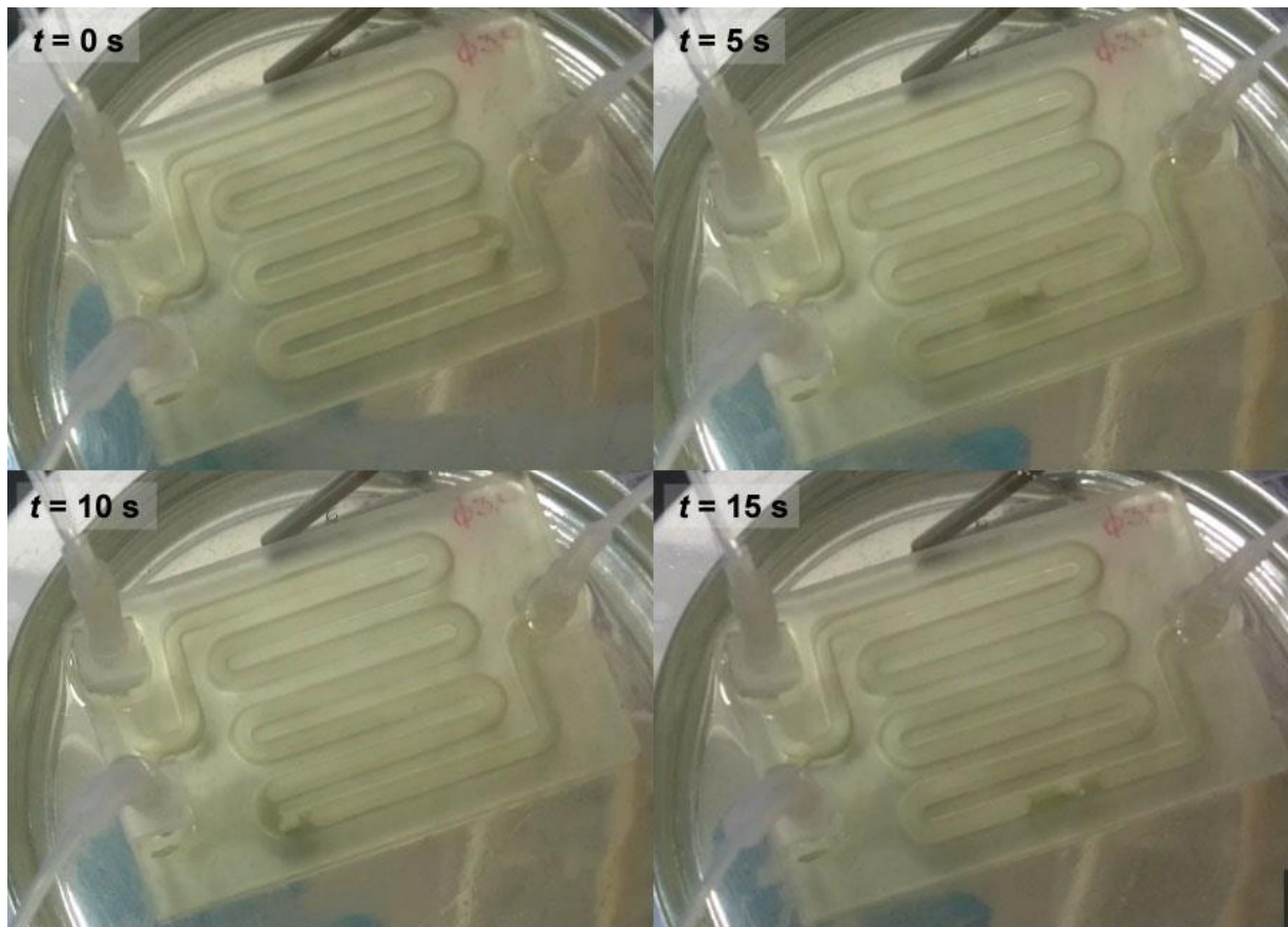
Slika 67. Fotografija milireaktora u uljnoj kupelji tijekom sinteze pri uvjetu T = 60\text{ }^{\circ}\text{C} , \varphi = 3,5\text{ mm} , \tau = 2,5\text{ mm} .
