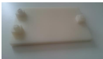
Slika 42. Reaktorski sustav izrađen na pisaču Zortrax M200. Korišten je materijal Z-ULTRAT ivory, vidljivo je čepljenje nastavaka na ulazu i izlazu iz reaktora.
