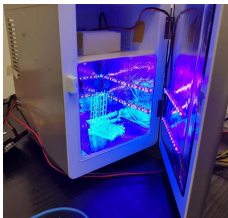
Slika 45. Komora opremljena LED svjetlom od 405 nm.
