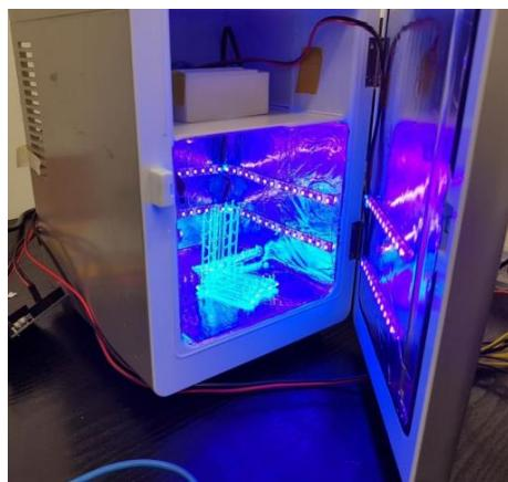
**Slika 45.** Komora opremljena LED svjetlom od 405 nm.
