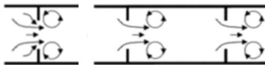
Slika 92. Shema pregrada i vrtloga koji se stvaraju strujanjem fluida.
