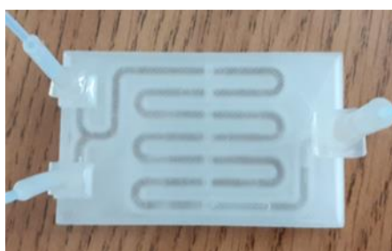
Slika 44. Milireaktor sa sedam pregrada na koji su nalijepljeni polipropilenski nastavci.
