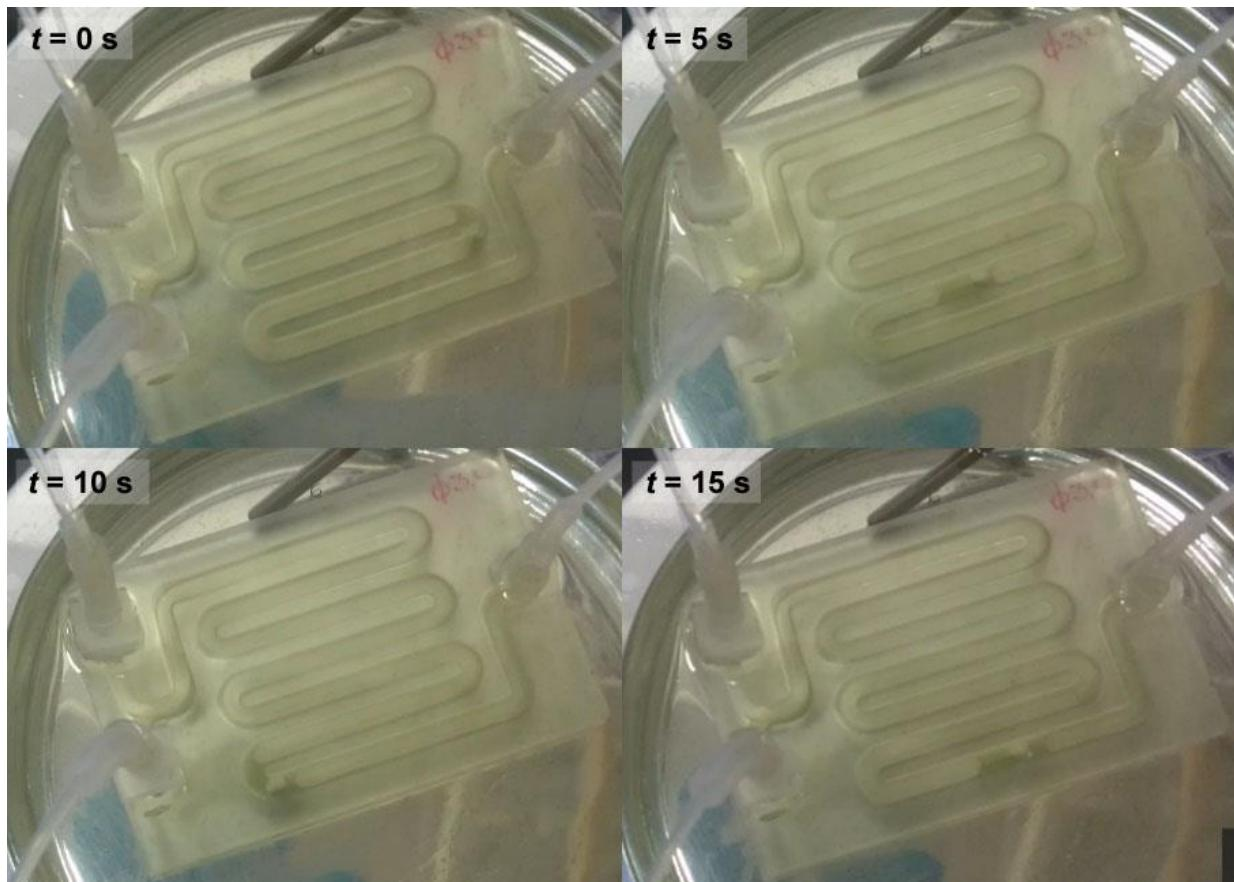
**Slika 67.** Fotografija milireaktora u uljnoj kupelji tijekom sinteze pri uvjetu
