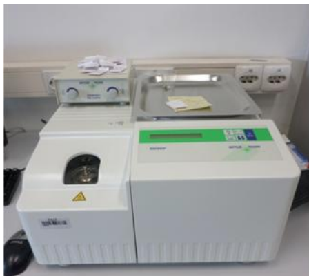
Slika 40. Razlikovni pretražni kalorimetar Mettler Toledo DSC 823 e .
