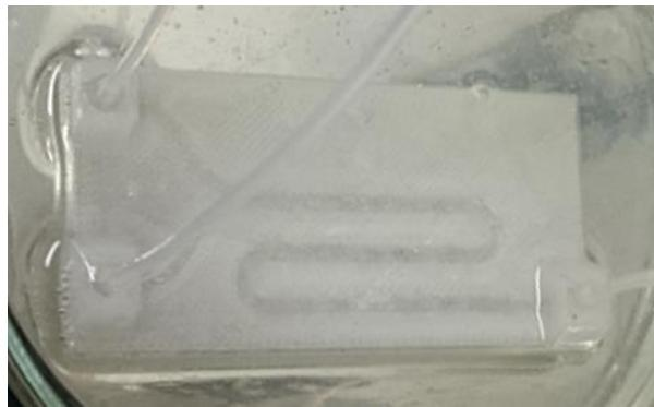
**Slika 95.** Fotografija RSP-120-FFF u uljnoj kupelji tijekom sinteze  $T = 60 \text{ } ^\circ\text{C}$  i  $\tau = 4,6 \text{ min.}$
