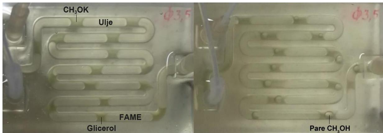
**Slika 60.** a) Fotografija milireaktora u uljnoj kupelji tijekom sinteze  $T = 50\text{ }^{\circ}\text{C}$ ,  $\phi = 3,5\text{ mm}$  (prva šprica ulje suncokreta, druga šprica metanol+KOH). b) Fotografija milireaktora u uljnoj kupelji tijekom sinteze  $T = 60\text{ }^{\circ}\text{C}$ ,  $\phi = 3,5\text{ mm}$ .
