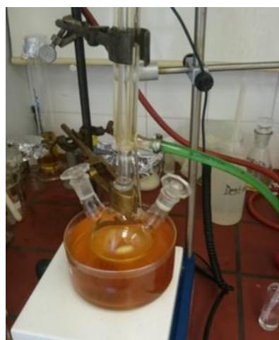
**Slika 34.** Prikaz šaržne sinteze FAME u tirkvici s povratnim hladilom.
