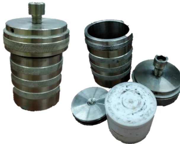
Slika 7. Zatvoreni hidrottermalni reaktor (lijevo) stavlja se u peć na određenu temperaturu i željeno trajanje reakcije. Unutar teflonske posude (desno) reakcija se odvija pri samogeneriranom tlaku koji odgovara tlaku zasićenih para iznad reakcijske otopine.
