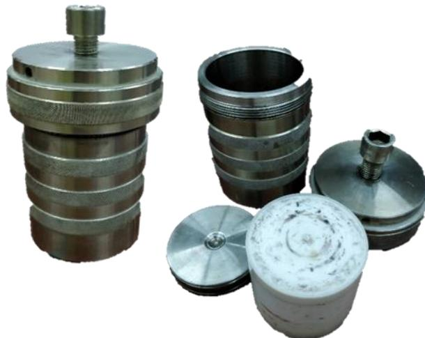
Slika 7. Zatvoreni hidrotermalni reaktor (lijevo) stavlja se u peć na određenu temperaturu i željeno trajanje reakcije. Unutar teflonske posude (desno) reakcija se odvija pri samogeneriranom tlaku koji odgovara tlaku zasićenih para iznad reakcijske otopine.
