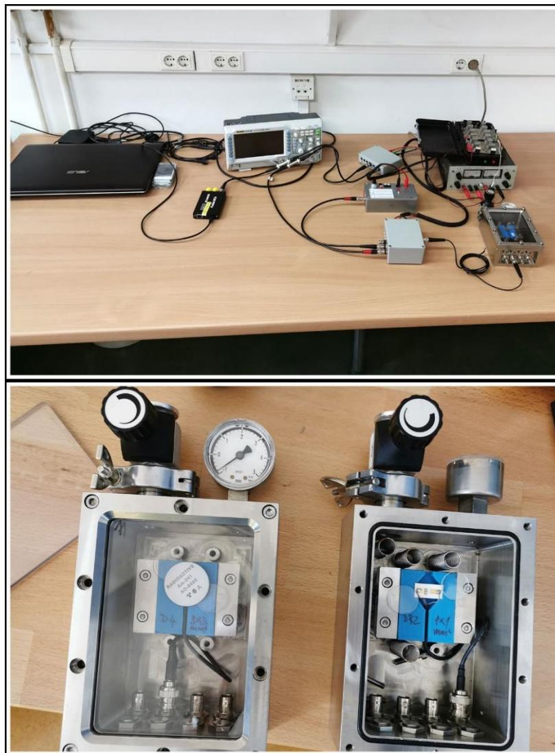
**Slika 27.** Fotografije detektorskog sustava (gore) i same vakumske komore sa Schottkyjevim diodama. Na fotografiji lijevo dolje prikazana je Schottkyjeva dioda u vakuumu. Na stakalcima debljine 2 mm nalazi se alfa-izvor  $^{241}\text{Am}$ .
