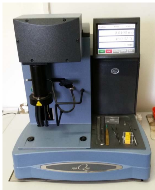
Slika 14. Uređaj za termogravimetrijsku analizu, TA Instruments Q500
