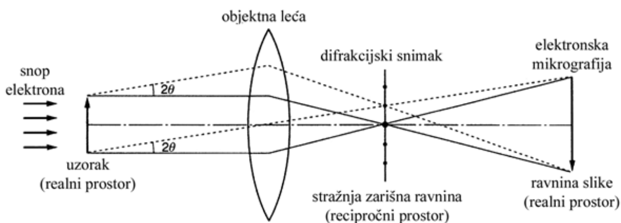
Slika 2.20. Princip nastajanja slike u TEM-u [91].
