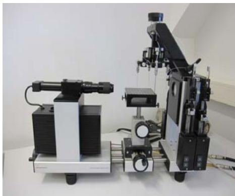
Slika 13. Goniometar, instrument za mjerenje kontaktnog kuta, DataPhysics OCA 20
