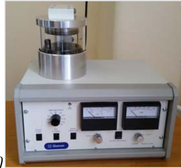
Slika 18. a) Pretražni elektronski mikroskop Tescan Vega serija 3, Bruker i b) uređaj za neparivanje vodljivog sloja zlata i napareni uzorci
