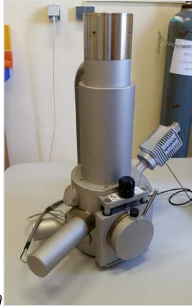
Slika 18. a) Pretražni elektronski mikroskop Tescan Vega serija 3, Bruker i b) uređaj za neparivanje vodljivog sloja zlata i napareni uzorci
