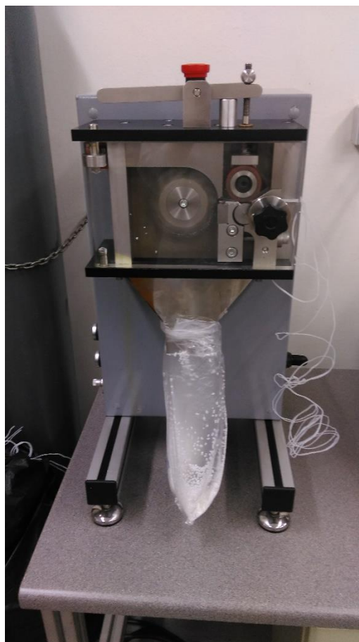
Slika 20. Granulator u sklopu dvopužnoga ekstrudera
