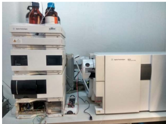
Slika 26. Mass Hunter Agilent Series 1200 HPLC sistem spojen s trostrukim kvadripolnim spektrometrom masa Agilent 6410 s elektroraspršenjem kao izvorom ionizacije
