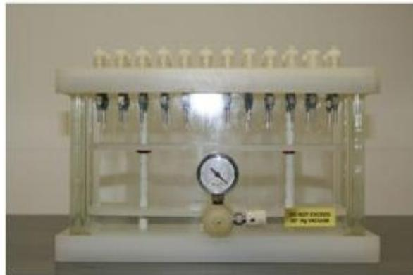
**Slika 3.2.** Supelco Visiprep 24 aparatura za ekstrakciju uzorka kroz čvrstu fazu
