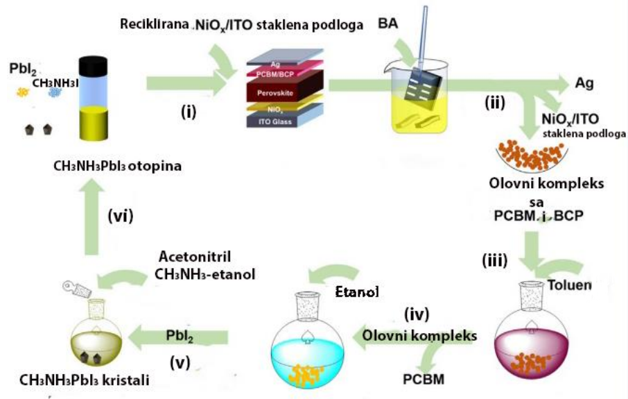
Slika 8. Shematski prikaz postupka recikliranja u zatvorenom krugu uređenom prema izvoru [14].
