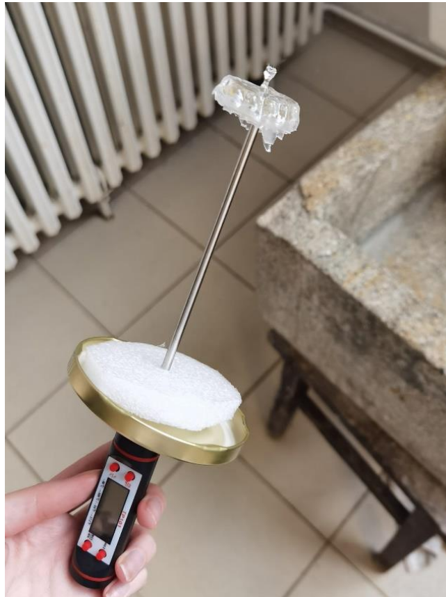
Slika 17. Očvrsnuta smola oko termometra
