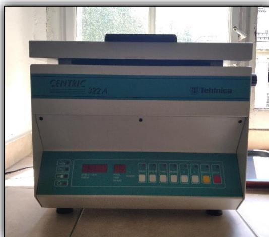
**Slika 17.** Centrifuga Tehnica Centric 322A.
