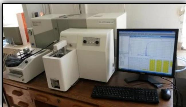
**Slika 13.** Uređaj laserske difrakcije *SALD-3101 (Shimadzu, Japan)*.
