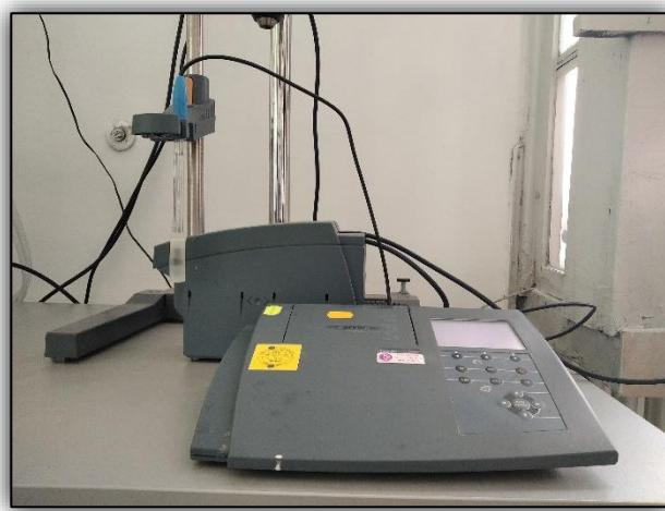
**Slika 14.** pH-metar s elektrodom.
