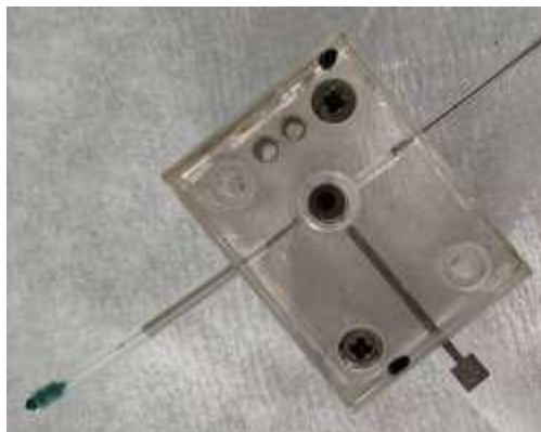
Slika 9. Ćelija za potenciometrijska mjerenja s ispisanim elektrodama.
