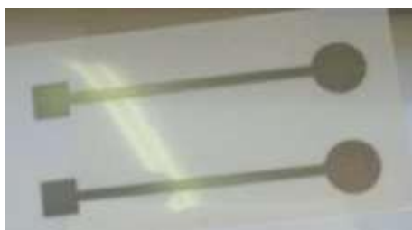
Slika 7. Ag elektrode otisnute inkjet pisačem na modificiranu PET podlogu.
