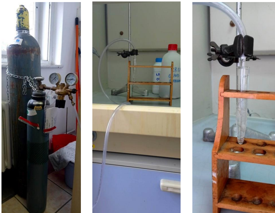
Slika 21. Aparatura za uparavanje otapala u struji dušika
