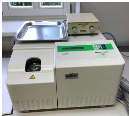
*Slika 28. DSC analizator 822<sup>e</sup>, Mettler Toledo*
