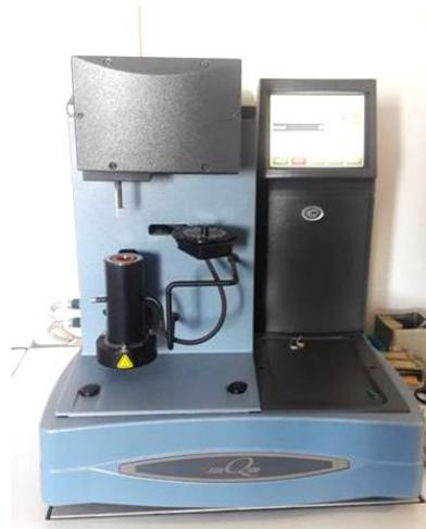
*Slika 30. Termogravimetar Q500 tvrtke TA Instruments*
