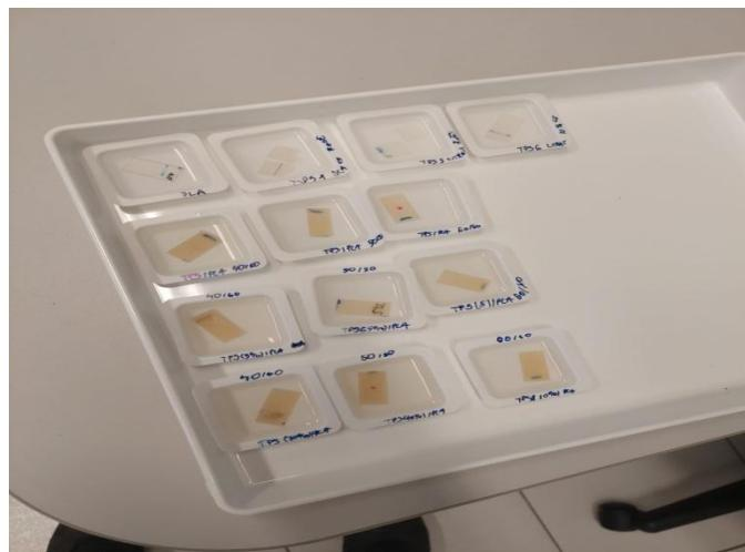
Slika 31. Ispitivani uzorci pripremljeni za test apsorpcije vode
