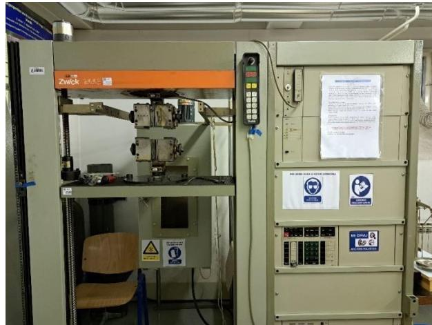
Slika 29. Univerzalna mehanička kidalica Zwick 1445
