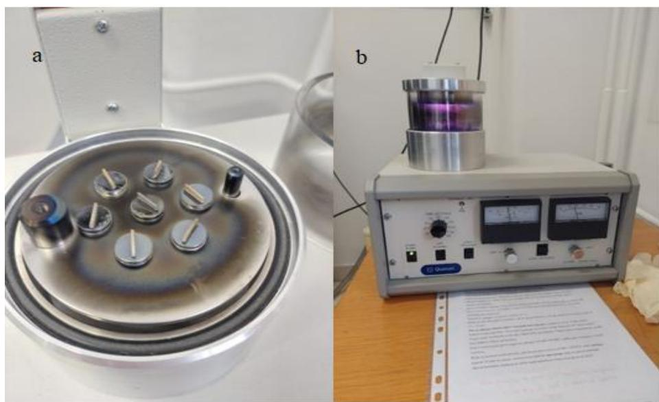
Slika 27. a) postavljanje uzorka na nosače za naparivanje, b) naparivač uzorka
