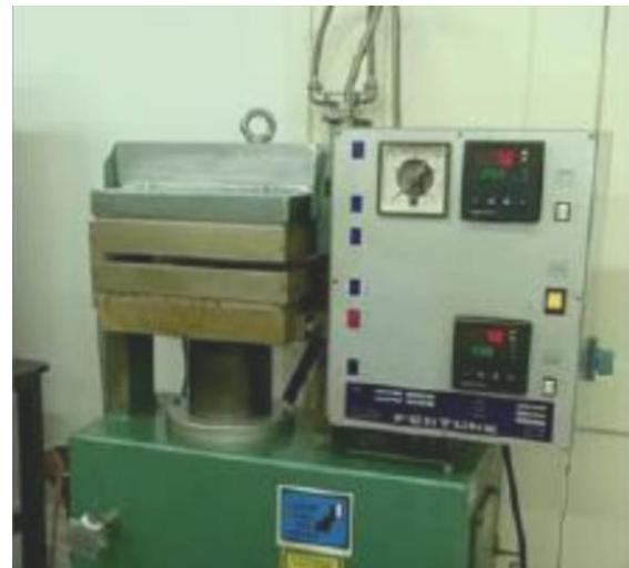
Slika 23. Hidraulička preša Fontuna
