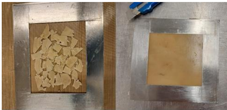
Slika 24. Materijal u kalupu; prije (lijevo) i nakon prešanja (desno)
