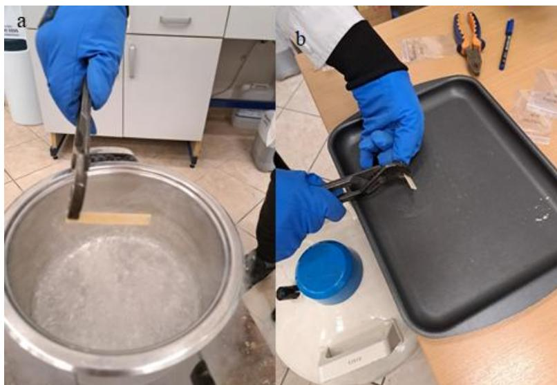
Slika 26. Tijek pripreme uzorka za snimanje SEM-om; a) smrzavanje materijala tekućim dušikom, b) kidanje materijala kliještim
