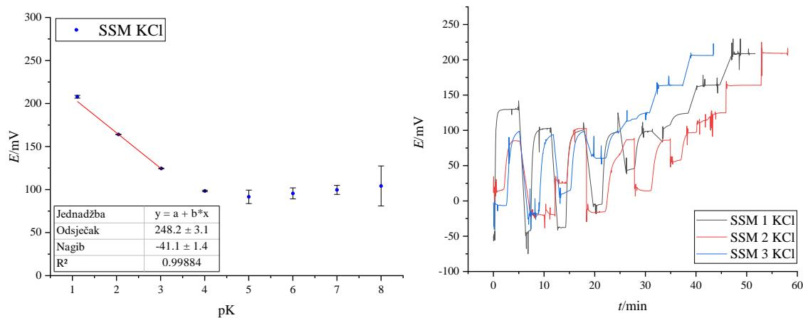
Slika 18. Kalibracijska krivulja (lijevo) i dinamički odziv amonij-selektivne elektrode snimljen metodom odvojenih otopina za određivanje koeficijenta selektivnosti K<sub>NH<sub>4</sub><sup>+</sup>,K<sup>+</sup></sub><sup>pot</sup>.
