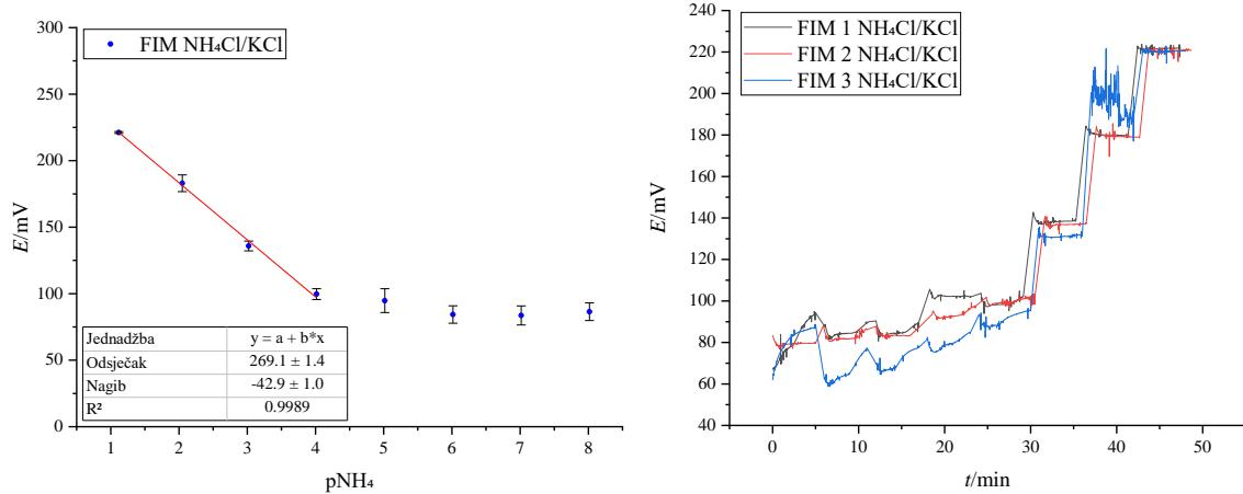
Slika 23. Kalibracijska krivulja (lijevo) i dinamički odziv amonij-selektivne elektrode snimljen metodom miješanih otopina za određivanje koeficijenta selektivnosti  $K_{\text{NH}_4^+, \text{K}^+}^{\text{pot}}$ .
