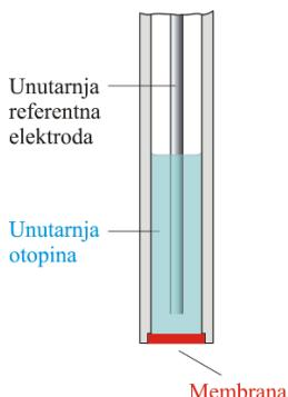
Slika 3. Ion selektivna elektroda s tekućim pretvornikom [5].
