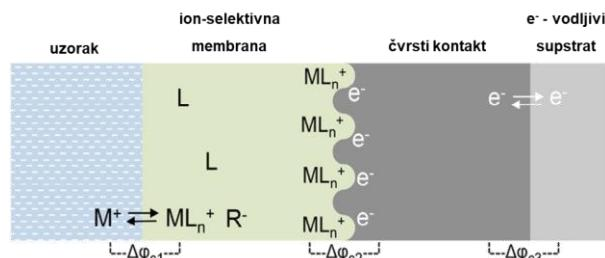
Slika 4. Ion-elektron pretvorba s čvrstom kontaktom visokog kapaciteta elektrokemijskog dvosloja [8].
