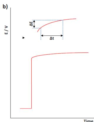
Slika 7. Određivanje vremena odziva ion selektivne elektrode [27].
