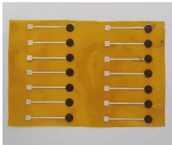
Slika 12. Elektrode s *inkjet* ispisanim čvrstim kontaktom,
