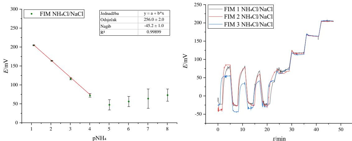
Slika 24. Kalibracijska krivulja (lijevo) i dinamički odziv amonij-selektivne elektrode snimljen metodom miješanih otopina za određivanje koeficijenta selektivnosti  $K_{\text{NH}_4^+, \text{Na}^+}^{\text{pot}}$ .
