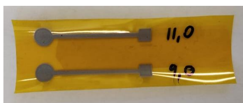
Slika 11. Inkjet ispisana srebrna elektroda, prije daljnje obrade.
