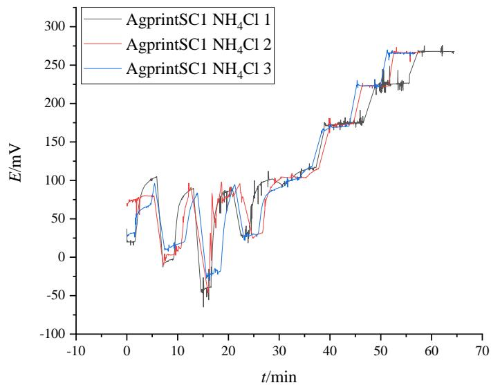
Slika 15. Dinamički odziv amonij-selektivne elektrode tijekom baždarenja u otopinama NH<sub>4</sub>Cl.
