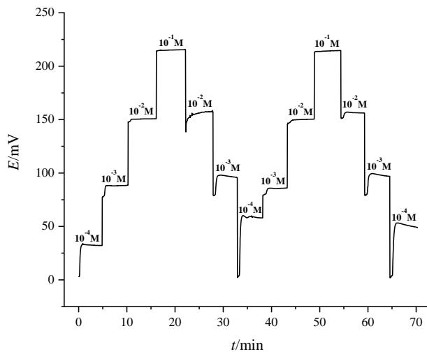
Slika 27. Mjerenje reverzibilnosti *inkjet* ispisane amonij-selektivne elektrode.
