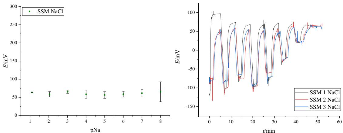
Slika 19. Kalibracijska krivulja (lijevo) i dinamički odziv amonij-selektivne elektrode snimljen metodom odvojenih otopina za određivanje koeficijenta selektivnosti  $K_{\text{NH}_4^+, \text{Na}^+}^{\text{pot}}$ .
