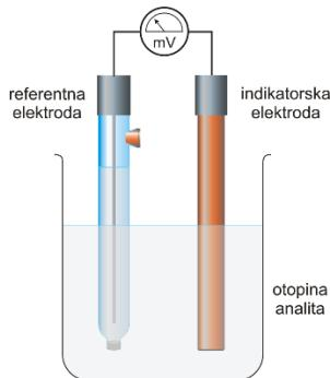
Slika 2. Elektrokemijska ćelija za potenciometrijsko mjerenje [5].
