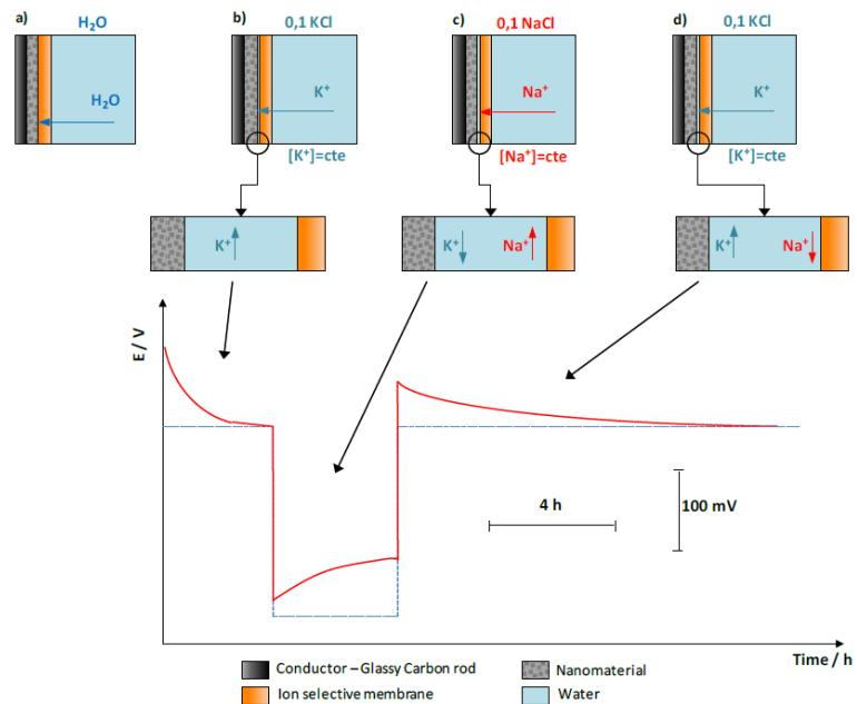
Slika 8. Test na vodenim slojem [27].
