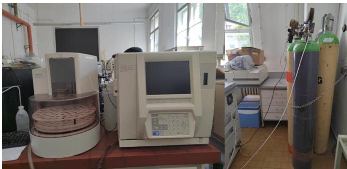
Slika 11. TOC-V<sub>CSH</sub> uređaj.
