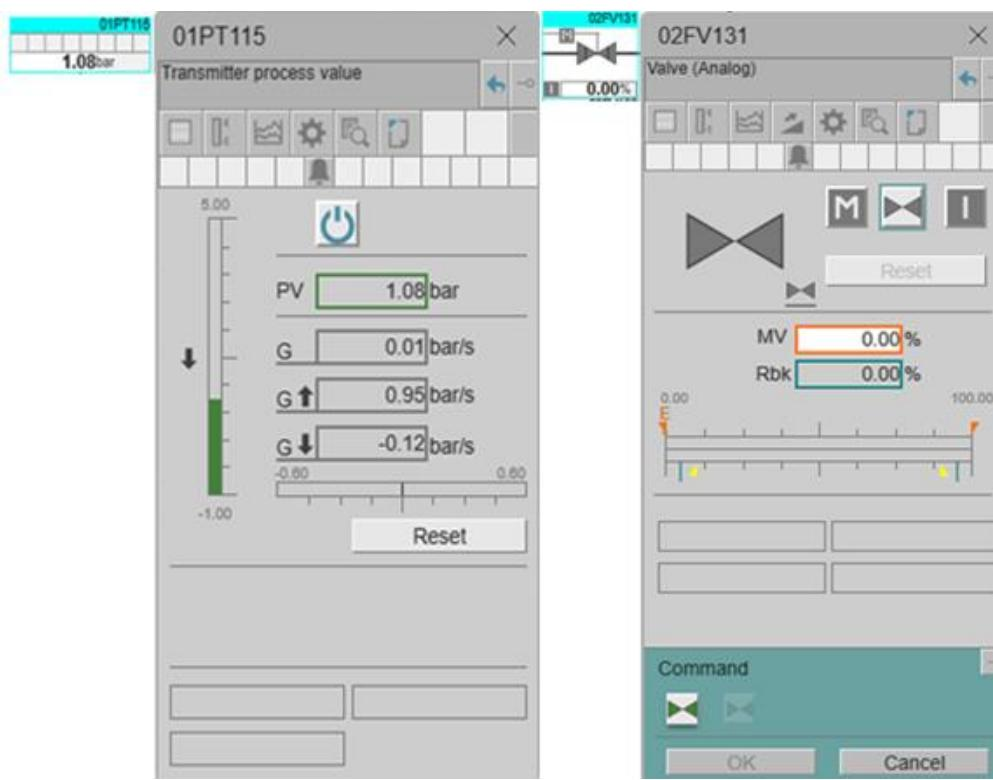
Slika 3.10 Grafički prikaz analognog nadziranja i regulacijskog ventila
