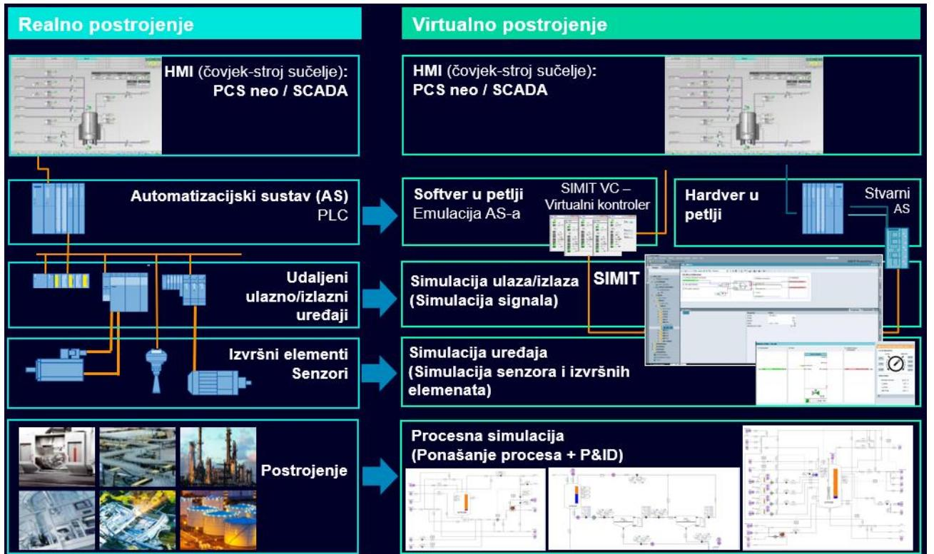
Slika 2.1 Usporedba elementa realnog i virtualnog postrojenja [4]
