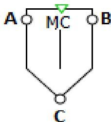
Slika 3.29 Simbol komponente Separator
