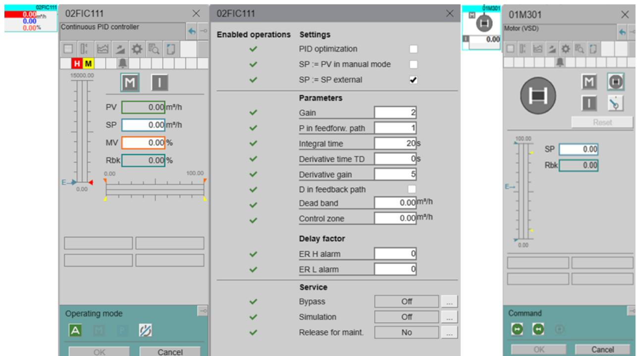
Slika 3.11 Grafički prikaz PID regulatora i motora
