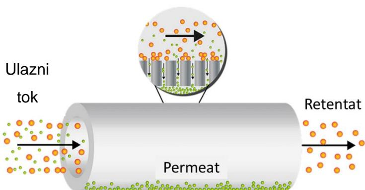
**Slika 2.6** Princip rada tangencijalne protočne filtracije [18]
