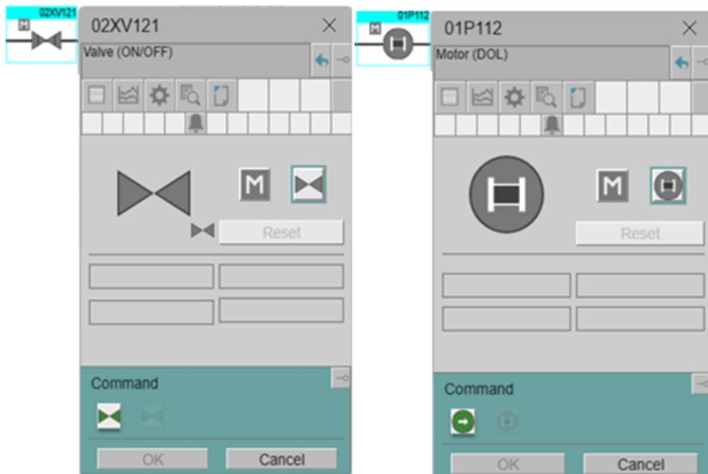
Slika 3.9 Grafički prikaz ventila i ON/OFF motora
