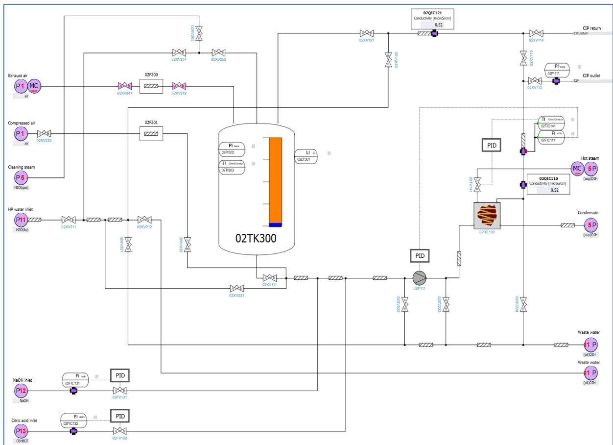
**Slika 4.4 Model procesa čišćenja sustava CIP postupkom unutar programske alate SIMIT Simulation Platform**
