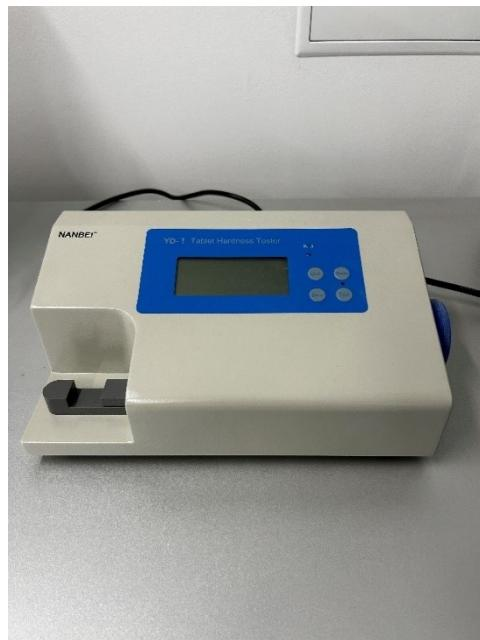
**Slika 18.** Uredaj za određivanje tvrdoće tableta YD – 1 Tablet Hardness Tester (Nanbei, Kina)
