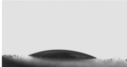
Slika 34. Kap dijodometana na uzorku API X MILL:PVP K30 1:3
