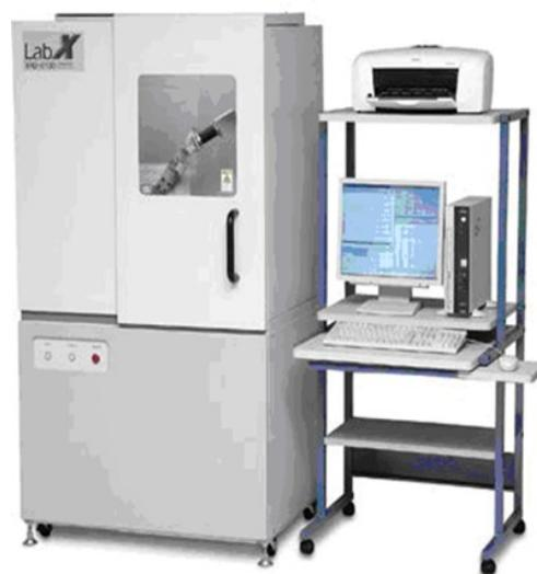
**Slika 12.** Uređaj za rendgensku difrakciju praha Shimadzu XRD – 6000
