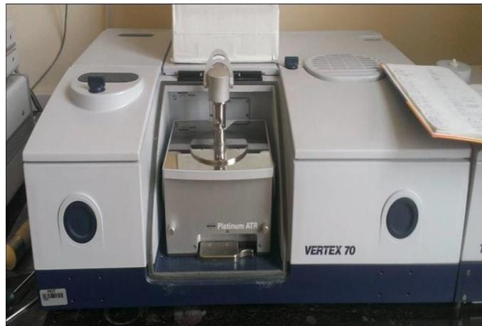
Slika 11. FTIR spektrofotometar Vertex 70 s platinastim detektorom
