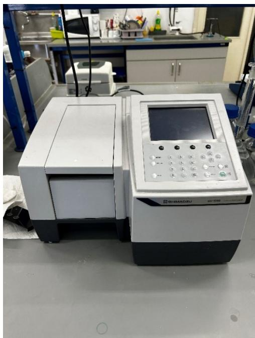
**Slika 20.** Spektrofotometar UV-1280
