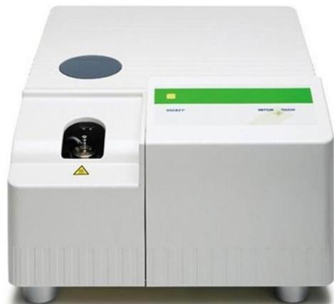
**Slika 9.** Diferencijalni pretražni kalorimetar
