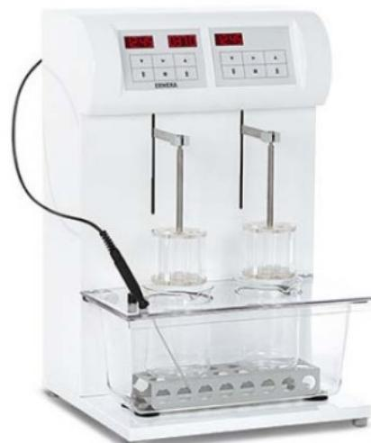
**Slika 19.** Uredaj za ispitivanje raspadljivosti tableta ZT 322
