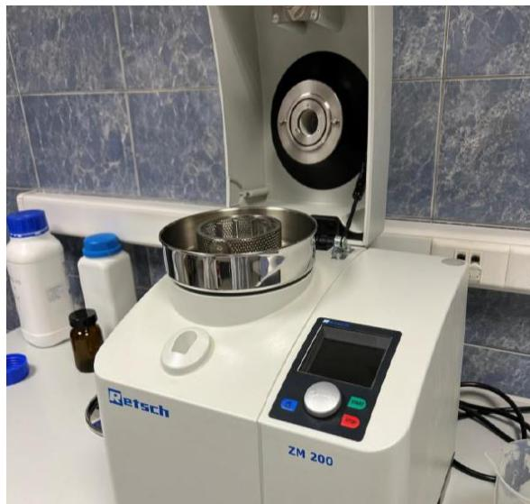
**Slika 16.** Retsch ZM 200 mlinu
