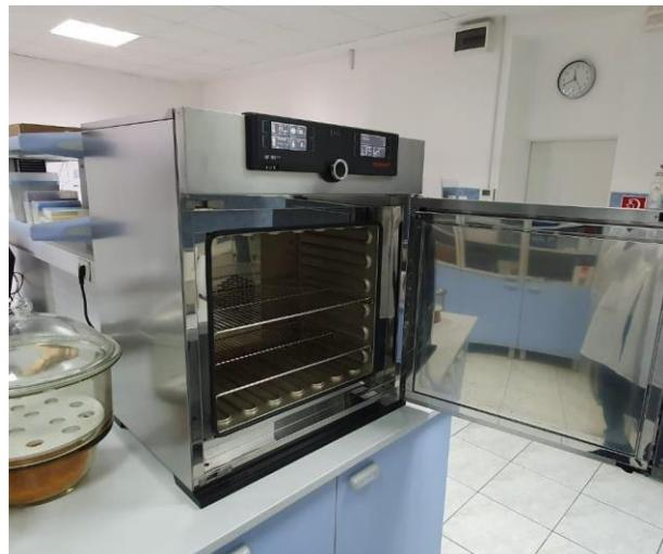
**Slika 15.** Memmert UF 110 peći za sušenje
