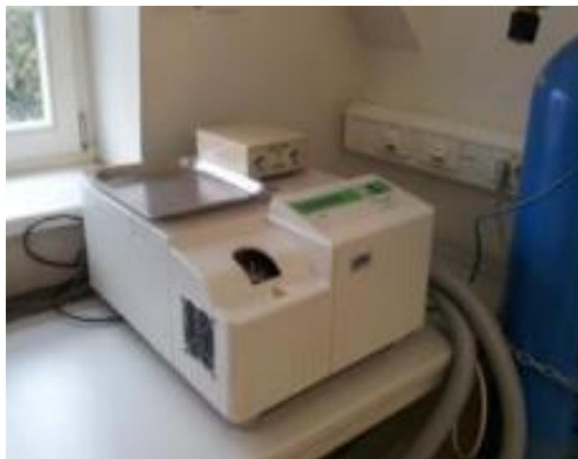
**Slika 22.** Diferencijalni pretražni kalorimetar Mettler Toledo DSC 822<sup>e</sup>
