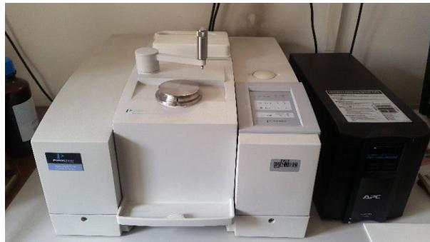
**Slika 21.** Spektrofotometar FT-IR Spectrum One, Perkin Elmer
