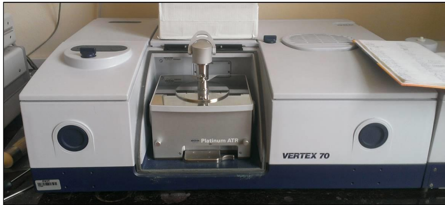
Slika 14. Fotografija FTIR spektrometra Vertex 70 s platinastim detektorom (Bruker, Billerica, SAD)
