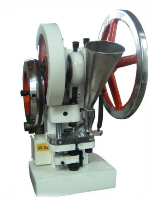
Slika 16. Fotografija uređaja za tabletiranje TDP-5T (Zhejiang Wisely Machinery Co., NR Kina)
