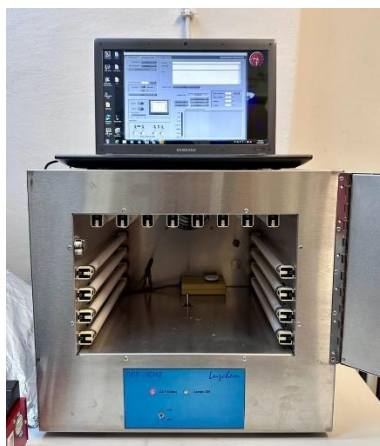
Slika 40. CCP-ICH2 fotokemijski reaktor proizvođača Luzchem.
