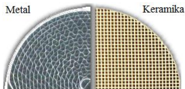
Slika 3.12 Monolitni katalitički supstrati [95]
