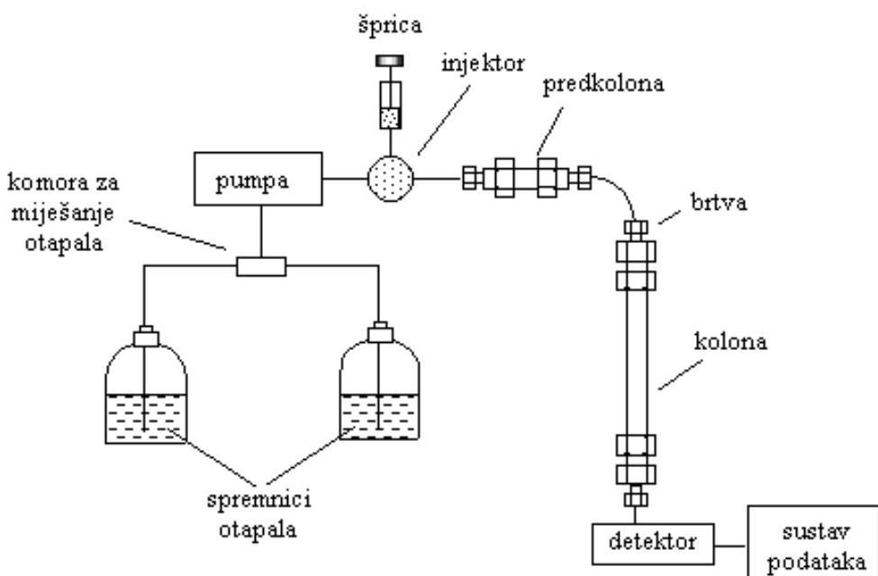
**Slika 5.** Shematski prikaz LC uređaja
