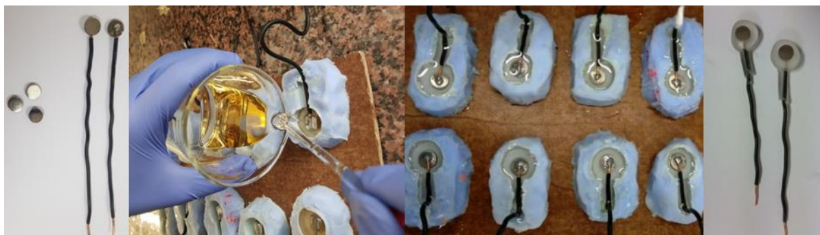
Slika 3.1. Postupak izrade radnih elektroda.
