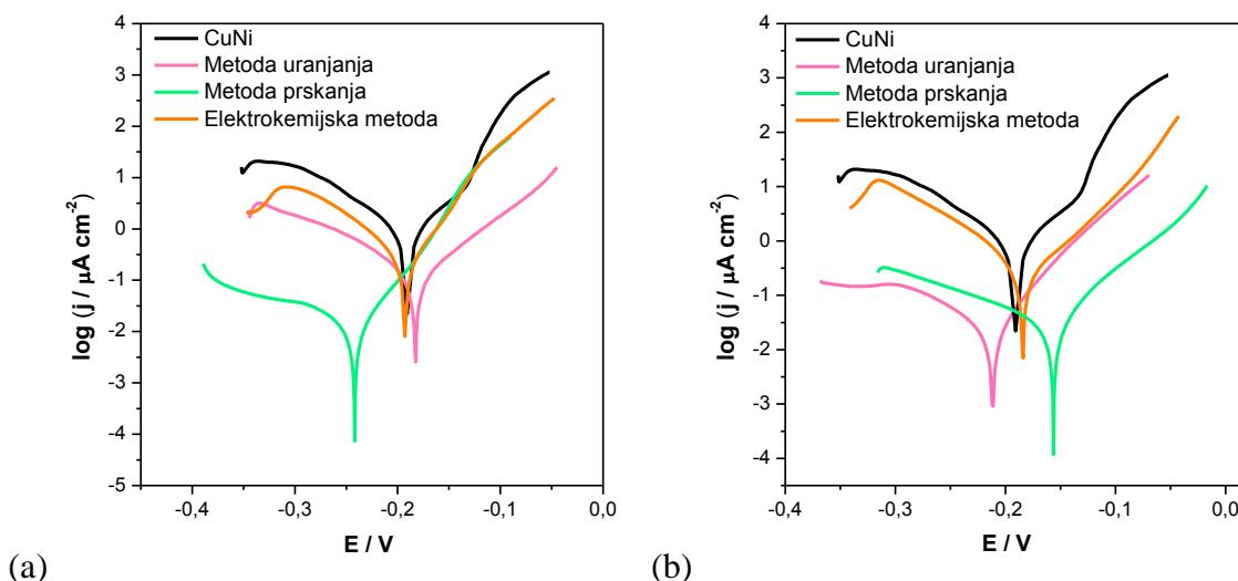
Slika 4.44. Usporedba polarizacijskih krivulja dobivenih ispitivanjem utjecaja metode pripreme filma: (a) SK, (b) ODPA.
