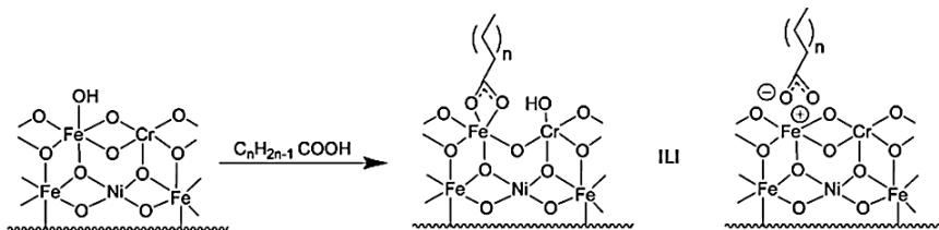
Slika 2.11. Predloženi mehanizmi vezanja organskih kiselina na metalnu površinu: kovalentno (lijevo) i ionsko vezanje karboksilne kiseline na SS316L.<sup>93</sup>
