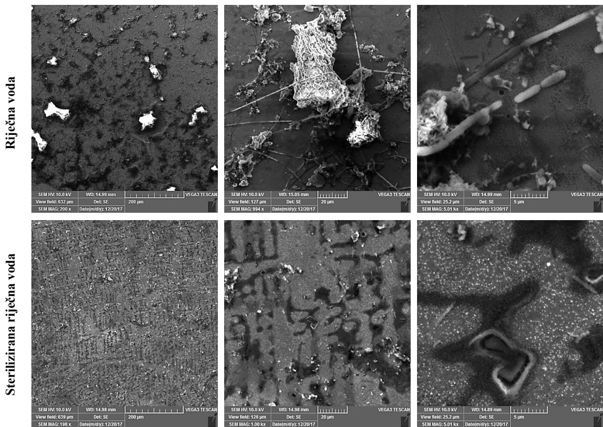
Slika 4.85. Netretirani uzorak CuNi legure nakon izlaganja prirodnjoj (gornje slike) te steriliziranoj (donje slike) riječnoj vodi snimljen pretražnim elektronskim mikroskopom pri povećanjima 200x, 1000x te 5000x.
