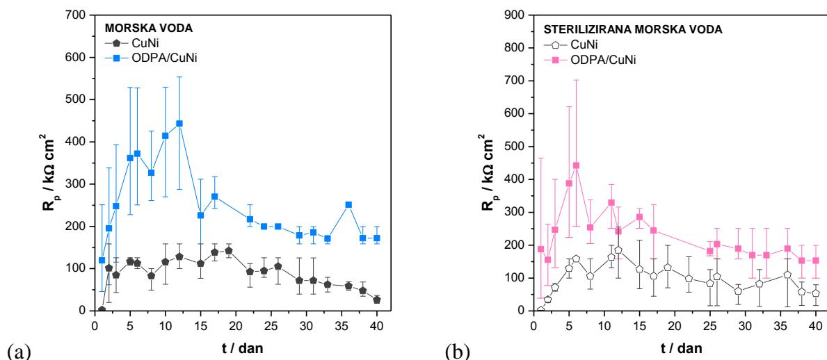
Slika 4.88. Ovisnost polarizacijskog otpora o vremenu za netretirane i tretirane CuNi uzorke u: (a) prirodnoj te (b) steriliziranoj morskoj vodi.
