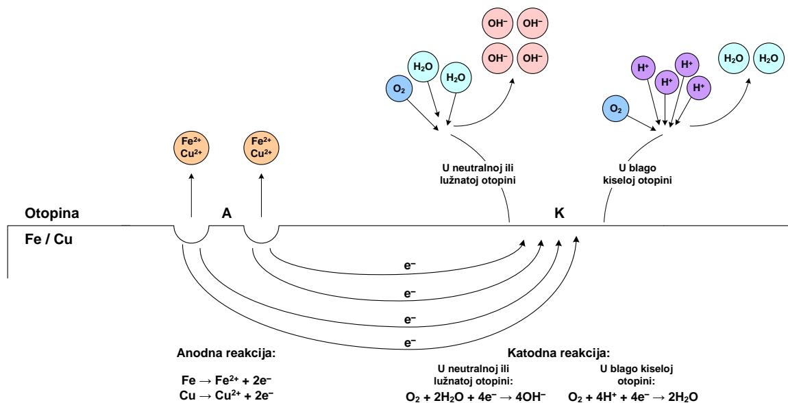
Slika 2.2. Shematski prikaz elektrokemijskog procesa korozije željeza ili bakra u neutralnoj ili lužnatoj te u blago kiseloj vodenoj otopini (nacrtano prema<sup>25</sup>).
