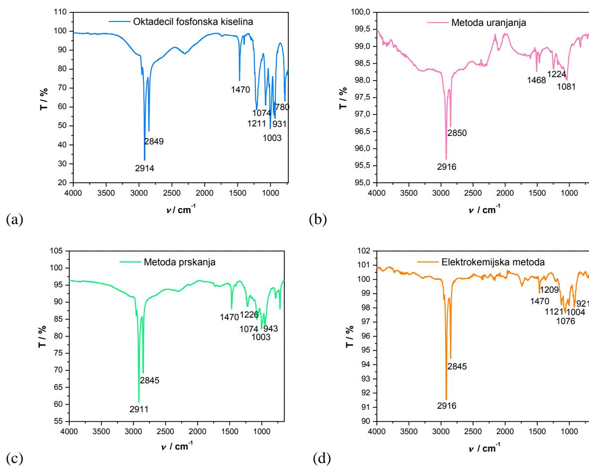
Slika 4.57. FTIR-ATR spektar čistog praha (a) te filmova oktadecil fosfonske kiseline nanesene: (b) metodom uranjanja, (c) metodom prskanja te (d) elektrokemijskom metodom.
