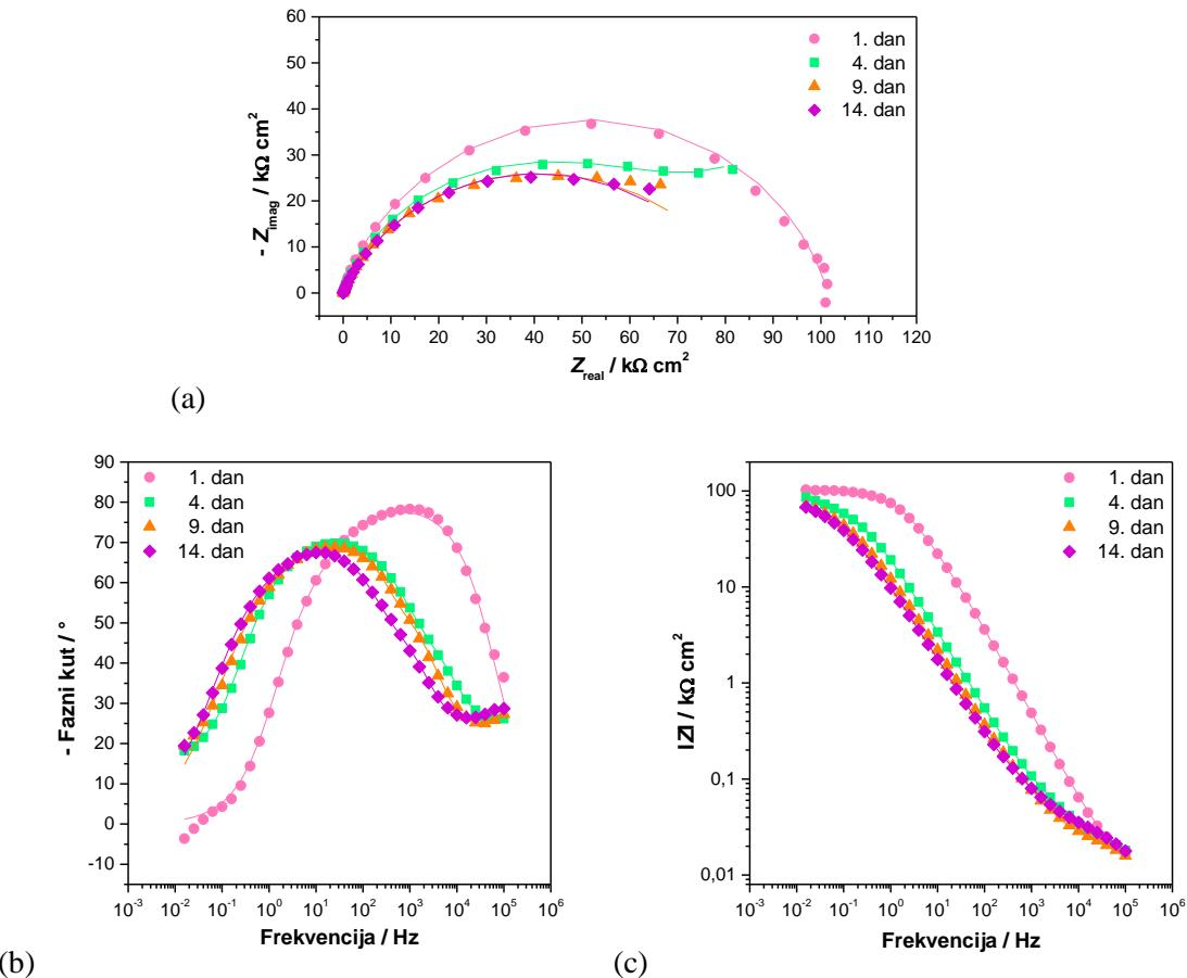
Slika 4.7. Impedancijske krivulje za A25°C, 72h uzorak: (a) Nyquistov prikaz, (b) i (c) Bodeov prikaz (simboli – eksperimentalni podaci, linije – rezultati dobiveni iz modela).
