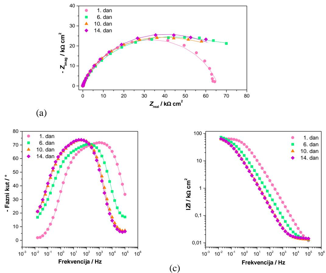
Slika 4.41. Impedancijske krivulje za B uzorak: (a) Nyquistov prikaz, (b) i (c) Bodeov prikaz (simboli – eksperimentalni podaci, linije – rezultati dobiveni iz modela).
