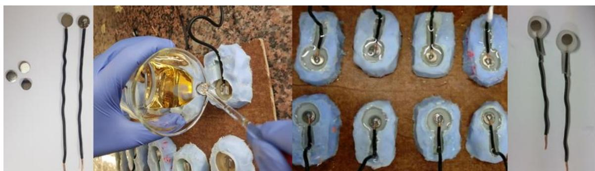
Slika 3.1. Postupak izrade radnih elektroda.
