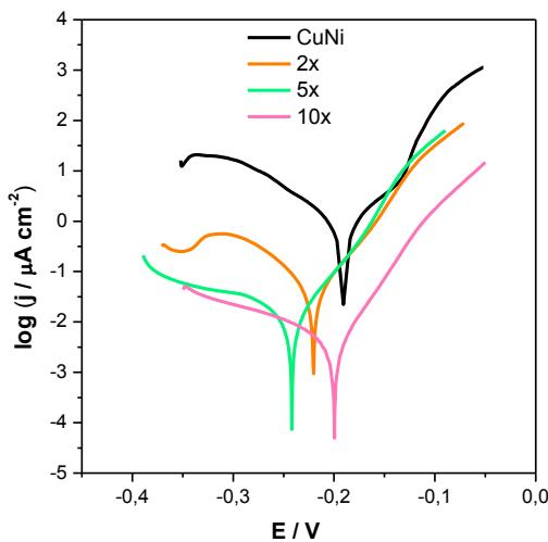
Slika 4.27. Polarizacijske krivulje dobivene ispitivanjem utjecaja broja prskanja.
