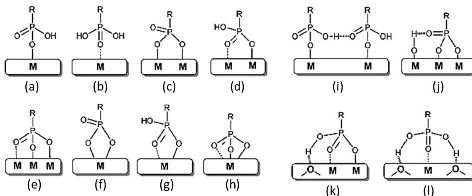
Slika 2.13. Načini vezanja fosfonskih kiselina na površinu metalnog oksida: (a) i (b) monodentatni način vezanja, (c) i (d) bidentatni način vezanja, (e) tridentatni način vezanja, (f) i (g) bidentatni način vezanja kelacijom, (h) tridentatni način vezanja kelacijom te (i), (j), (k) i (l) različite interakcije vodikove veze.<sup>97</sup>
