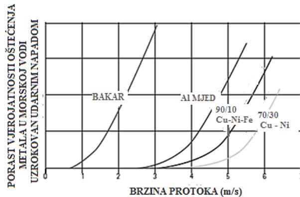
Slika 2.7. Povezanost udarnog napada i brzine protoka za bakar i njegove legure.<sup>2</sup>
