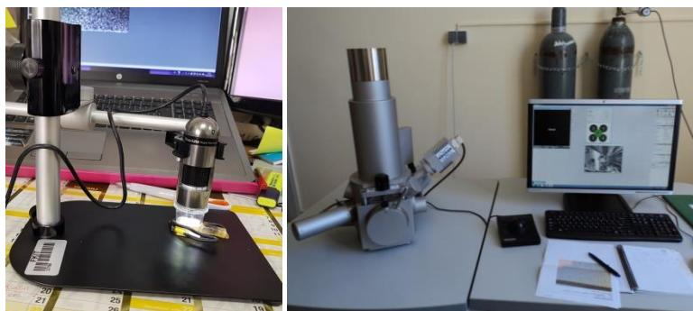
Slika 3.25. Optički (a) i pretražni elektronski (b) mikroskop.
