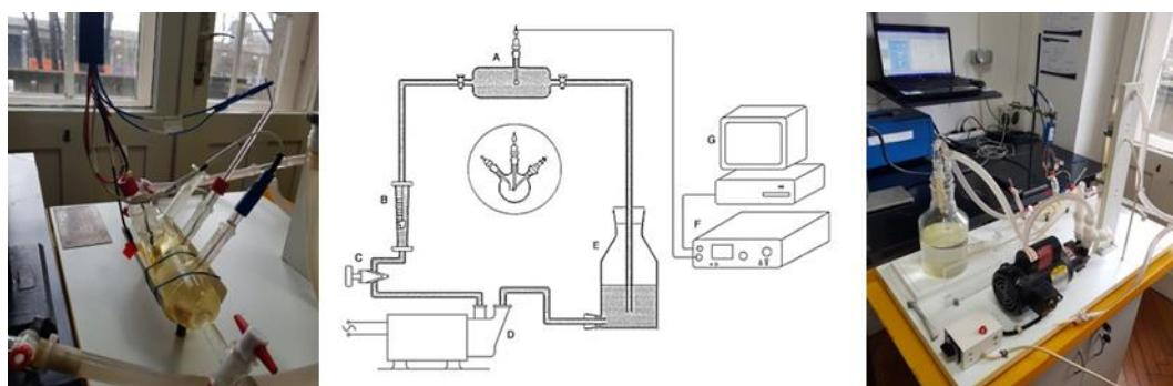
Slika 3.8. Shematski prikaz i fotografije aparature korištene pri korozionskim ispitivanjima u protočnim uvjetima.
