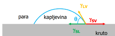
Slika 3.19. Youngov kontaktni kut na idealnoj površini.
