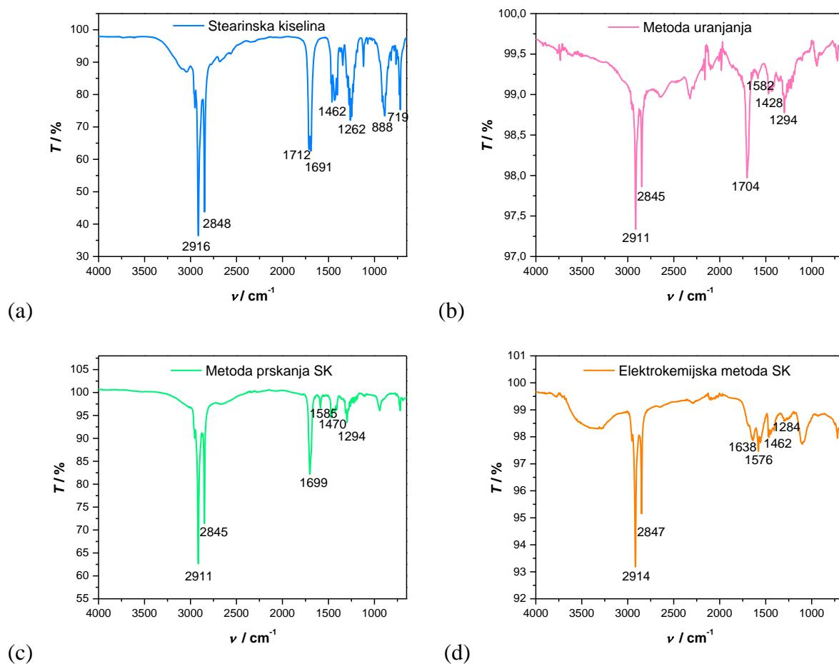
Slika 4.55. FTIR-ATR spektar čistog praha (a) te filmova stearinske kiseline nanesene: (b) metodom uranjanja, (c) metodom prskanja i (d) elektrokemijskom metodom.
