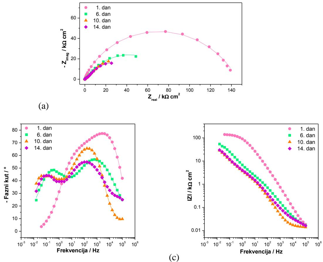
Slika 4.24. Impedancijske krivulje za t10 uzorak: (a) Nyquistov prikaz, (b) i (c) Bodeov prikaz (simboli – eksperimentalni podaci, linije – rezultati dobiveni iz modela).
