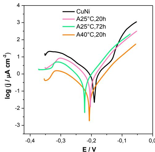
Slika 4.1. Polarizacijske krivulje dobivene ispitivanjem utjecaja temperature i vremena adsorpcije u otopini ODPA.
