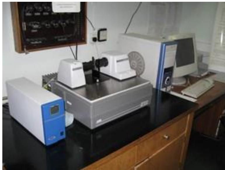
Slika 20. ABB Bomem MB 102 FTIR-ATR spektrometar<sup>81</sup>
