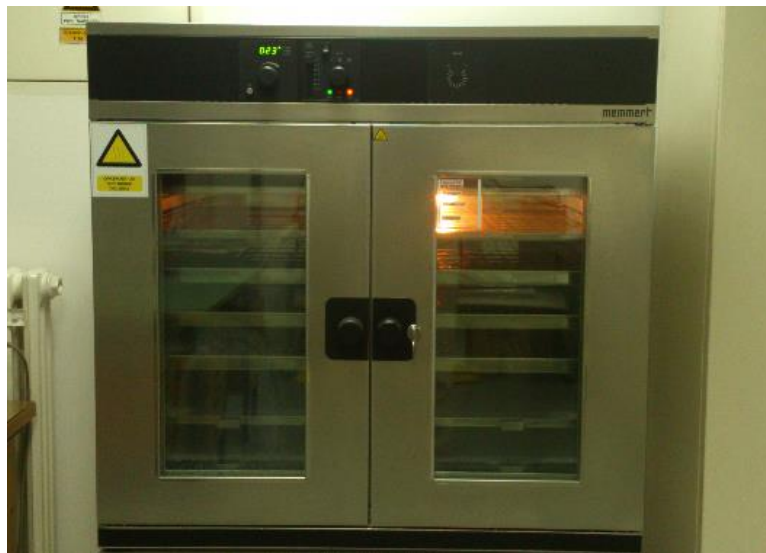
Slika 18. Memmert, loading modell 100-800 komora u kojoj je provedeno toplinsko starenje
