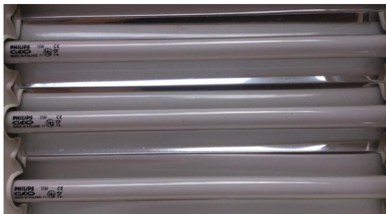
Slika 19. Philips Cleo Compact UV žarulje kojima je provedeno starenje zračenjem
