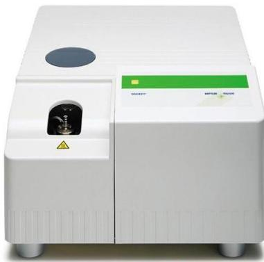
Slika 24. Uredaj za diferencijalnu pretražnu kalorimetriju, *Mettler Toledo DSC 823e*<sup>94</sup>
