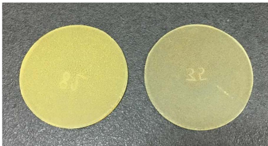
**Slika 4.42.** Usporedba imobiliziranog sloja  $\text{TiO}_2\text{-SnS}_2\text{-HT}$  ( $w(\text{SnS}_2)=40\ \%$ ) pripremljenog „pre-spin“ modificiranim postupkom (lijeva pločica) s jednim slojem (desna pločica).
