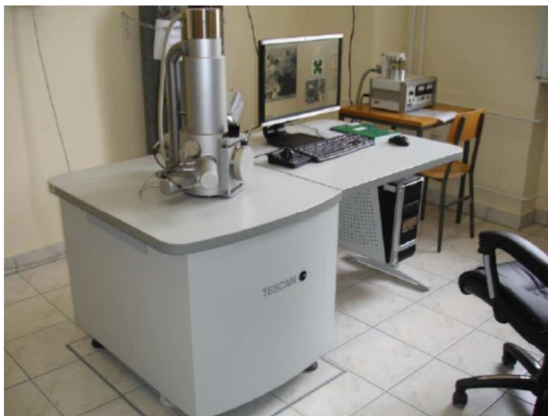
Slika 34. Pretražni elektronski mikroskop Tescan Vega 3 SEM
