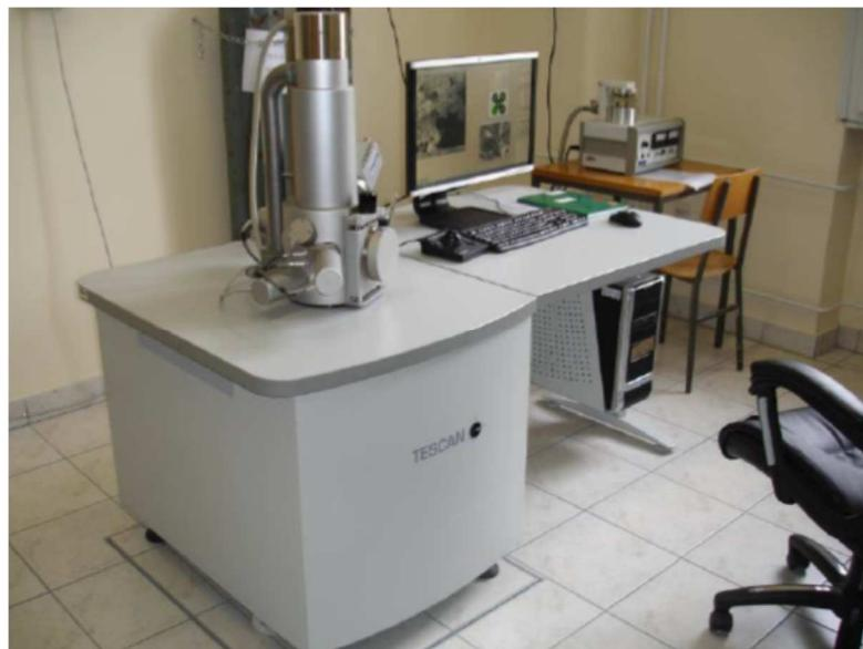
**Slika 34. Pretražni elektronski mikroskop Tescan Vega 3 SEM**
