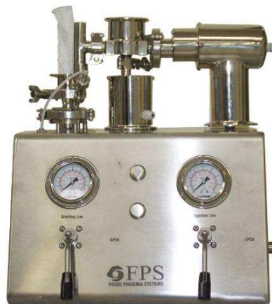
Slika 26. Laboratorijski spiralno strujni mlin LaboMill, FPS
