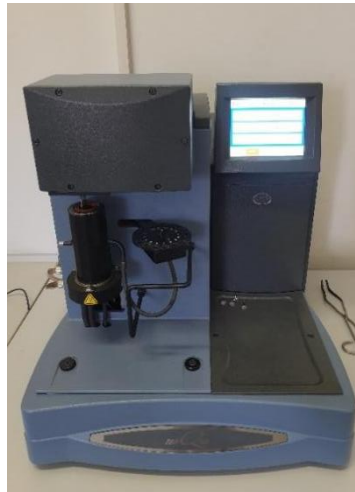
Slika 23. Termogravimetrijski analizator Q500, TA Instruments
